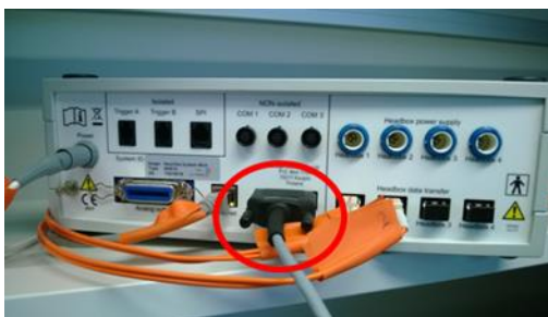
Kuva 8. Trigger I/O -liitäntä ympyröity
