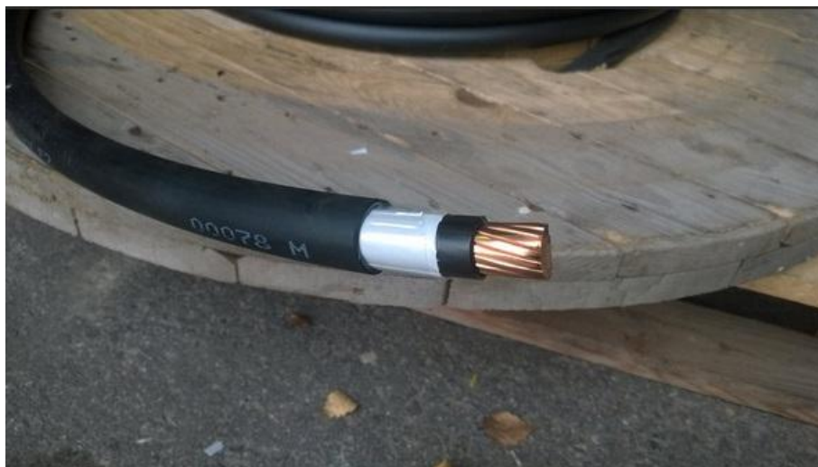
Kuva 5. Pj-välikaapeloinnissa käytetty kuparikaapeli XMK-PLUS 1x185
