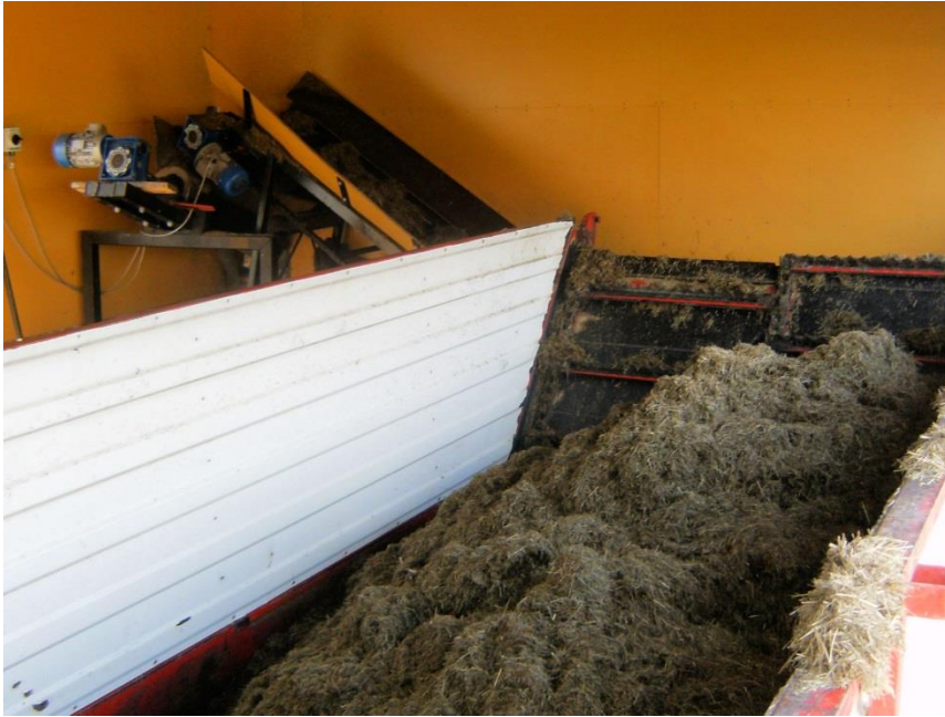
KUVIO 11. Säilörehun syöttö biokaasureaktoriin.
