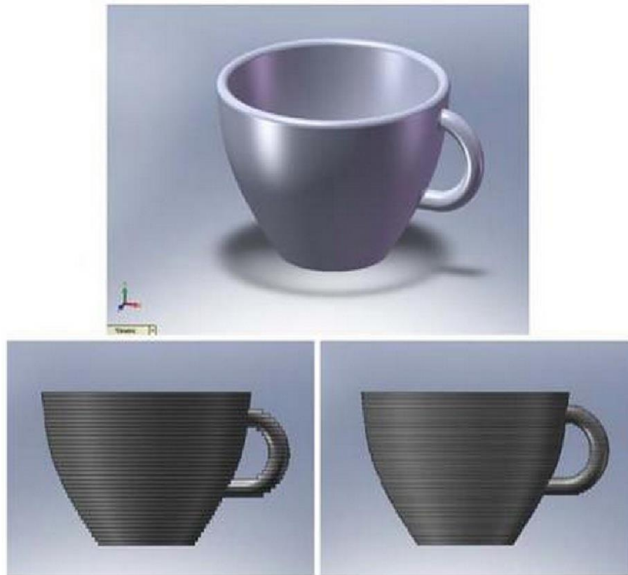
Kuva 2. Ylhäällä 3D-CAD malli. Vasemmalla kappale jaettu kerroksiksi isoa resoluutiota käyttäen. Oikealla resoluutiota on pienennetty ja kappaleen valmistustarkkuus kasvaa [2, s. 2]
