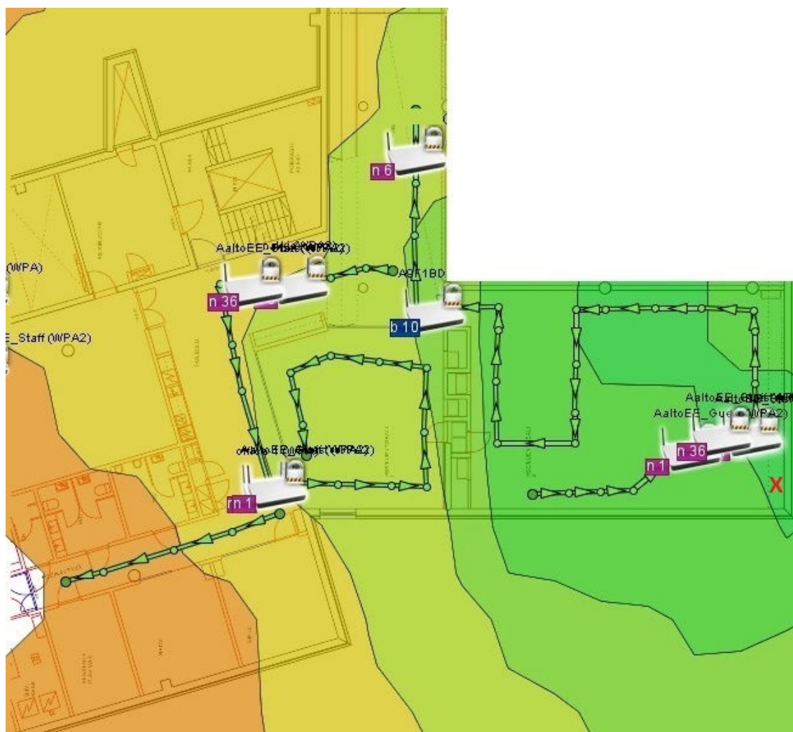
Kuva 1. Mittaustulos yläkellarin tukiasemasta 1.
