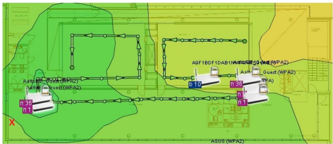
Kuva 5. Mittaustulos 2. kerroksen asiakastilojen tukiasemasta 1.
