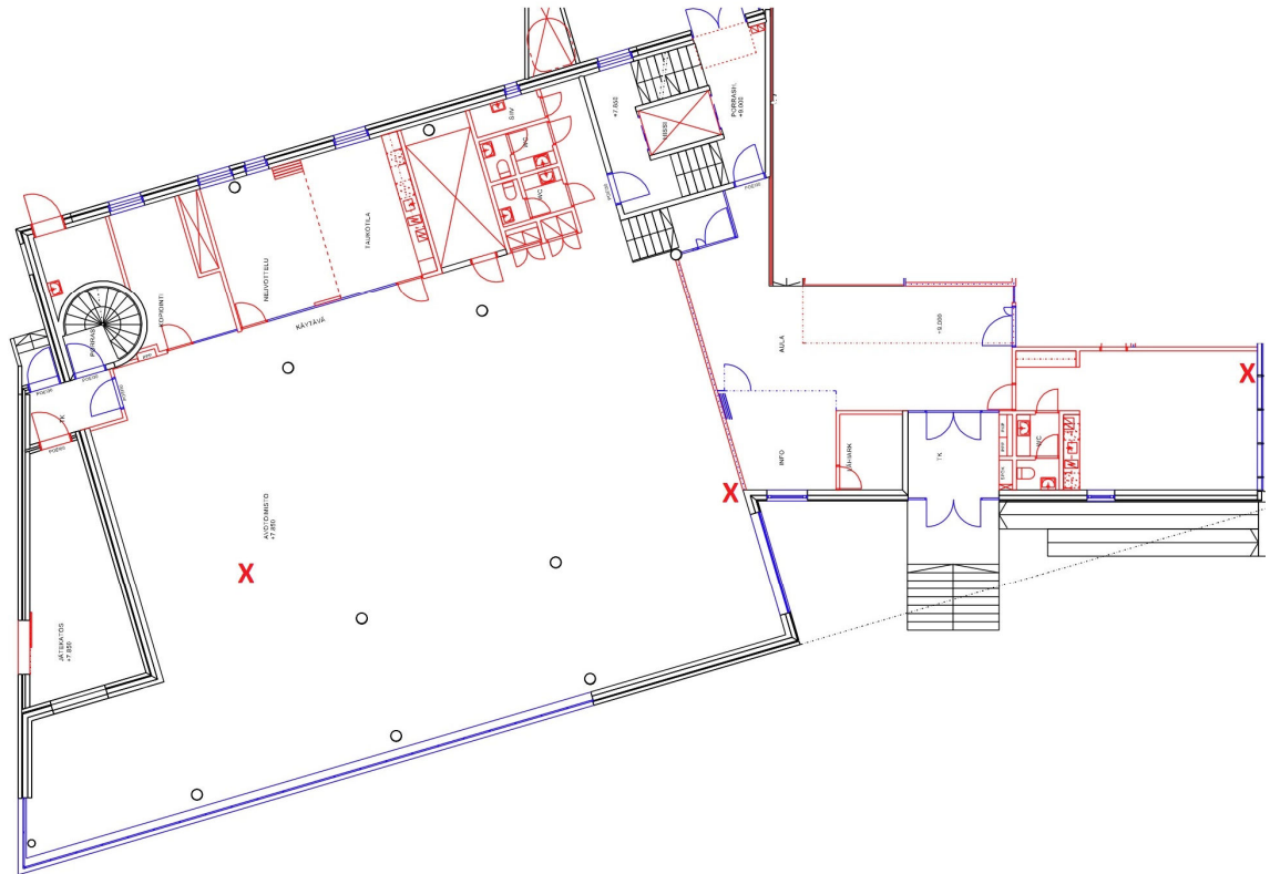
Kuva 2. 1. kerrokseen sijoitetaan kolme tukiasemaa. Isossa asiakastilassa käytetään vanhojen tukiasemien sijoituspaikkoja ja neuvotteluhuoneeseen lisätään yksi sijoituspaikka.
