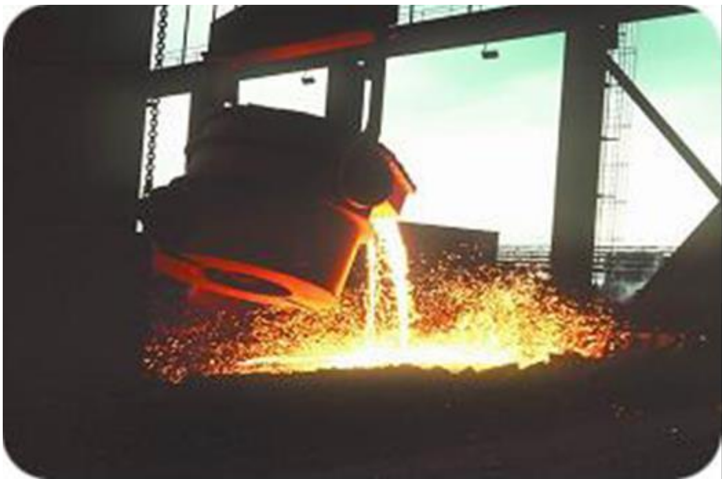
Kuva 6. Sula ferrokromi valetaan valuojaan.
