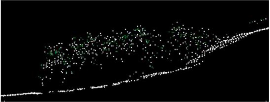
KUVA 6. Laserkeilauspistepilveä kasvillisuuden aiheuttamista katkoksista.
