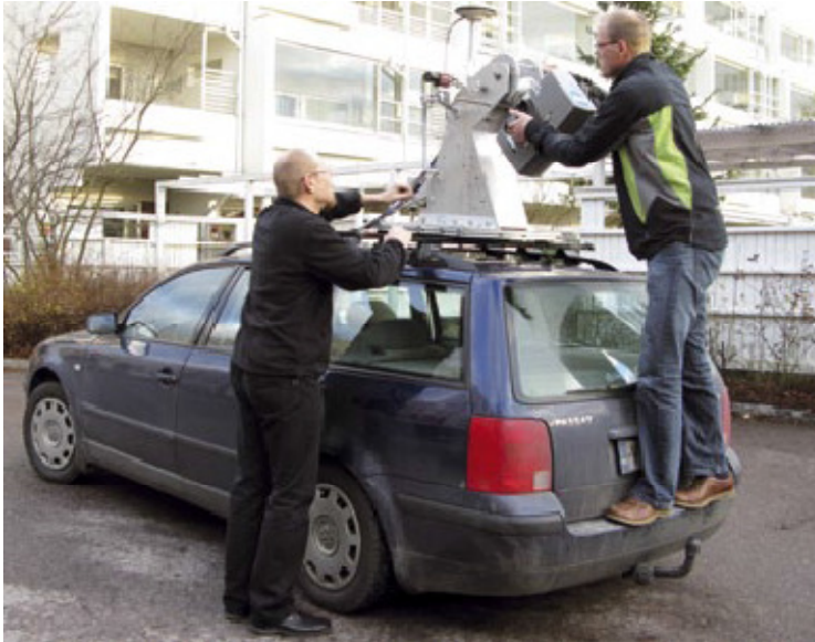
KUVA 4. Kartoitustilanteiston asentamista auton katolle. (Positio 2/2010, 7. )
