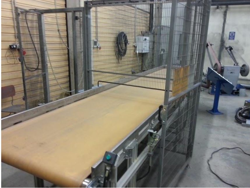
Kuva 7. Operaattori asettaa hiontaan menevät kappaleet liukuhihnalle solun ulkopuolella.
