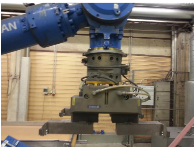
Kuva 12. PGN-plus 200-2 -tarttuja sormineen kiinni robotissa.
