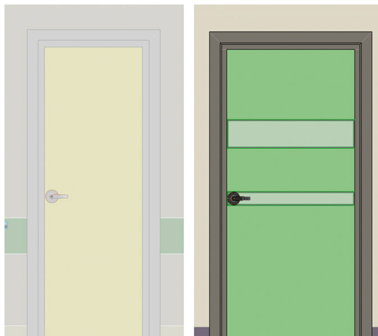
Kuva 11. Ovi ei erotu ja ovi erottuu.
