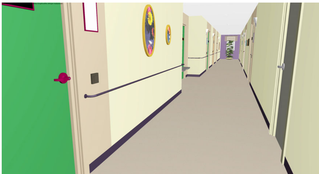
Kuva 22. Syvennys keskellä käytävää. Huomioitavaa: henkilökunnan ovi ei erotu seinästä, sen sijaan asukkaiden ovesa on käytetty kontrastivärejä.
