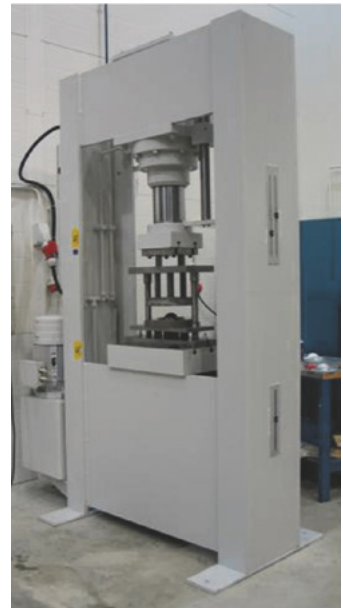
Kuva 11. Rajamuovattavuuskäyrän määrittämiseen käytetty muovauspuristin.
