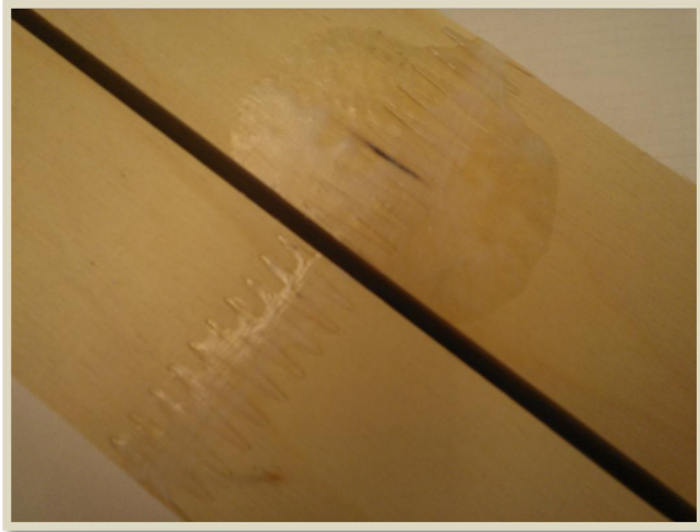
KUVIO 26. Liimatut ja kavennetut liitokset testausta vaille
