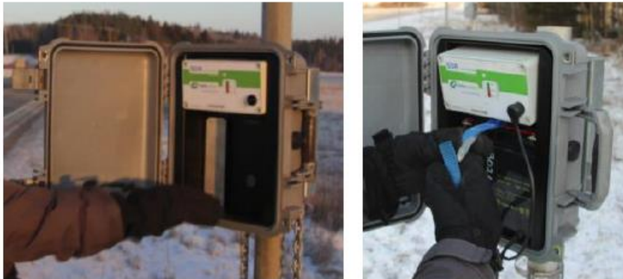
Kuva 5: Akku laitetaan laskimen alapuolelle sille tarkoitettuun paikkaan. Laskentalaiteen mukana on akulle oma kiinnike, joka voi olla metallinen pidike tai kiristysliina.
