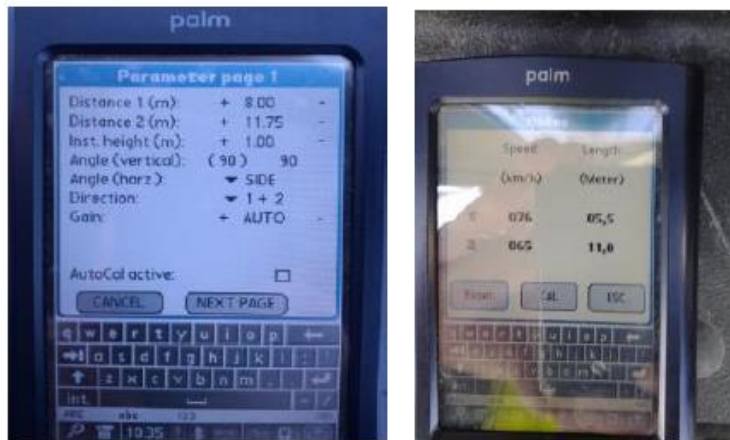
Kuva 7: Palmiin laitetaan vaadittavat parametrit. Online-tilasta voidaan katsoa ohimenevien autojen pituuden, suunnan sekä nopeuden.
