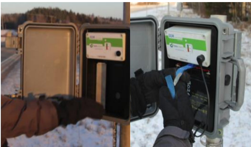
Kuva 14. Akku laitetaan laskimen alapuolelle sille tarkoitettuun paikkaan. Laskentalaitteen mukana on akulle oma kiinnike, joka voi olla metallinen pidike tai kiristysliina.
