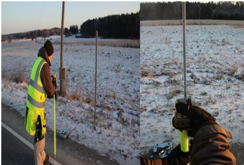
Kuva 9. Lasermitta asetetaan tien reunalle, josta mitataan etäisyys asennustolppaan.
