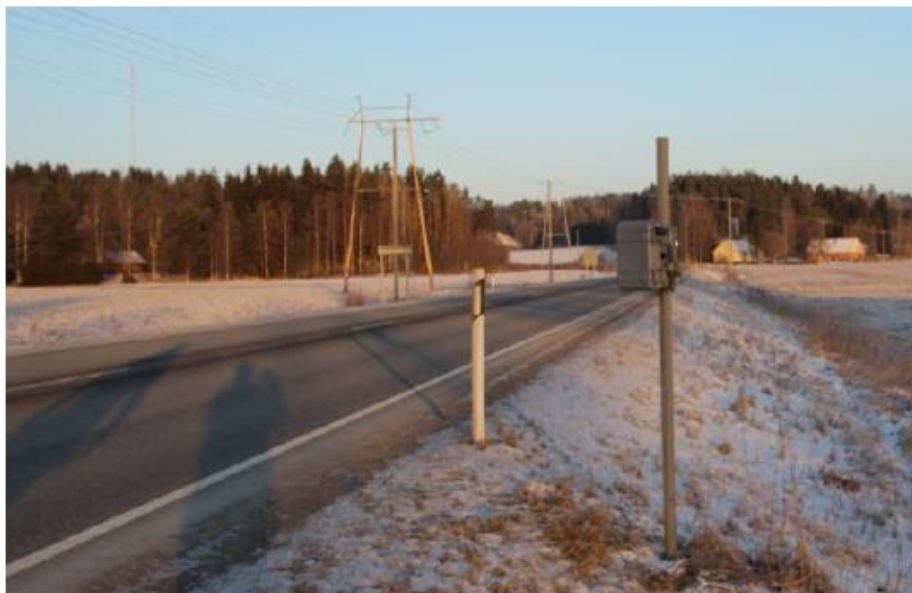
Kuva 8: Liikennelaskimen ovet lukitaan ja laitteen ympärille asennetaan vahva ketju. Laskin ja kiinnike lukitaan ketjuun.
