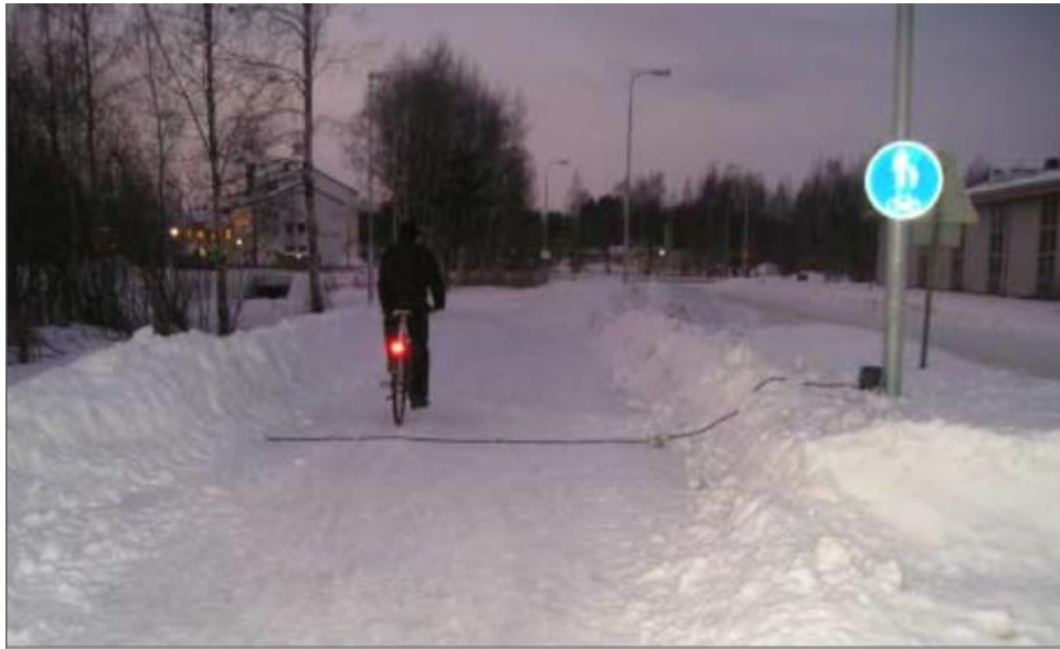
Kuva 4. Letkuilmaisin on jalankulku- ja polkupyörä väylälle asennettu. Itse laskentalaite on valaisinpylään juuressa. Kuvan tilanne on demonstroitu. (Liikenne- ja viestintäministeriö 2005.)
