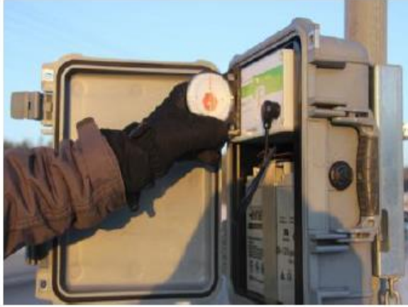
Kuva 6: Kulmamittari asetetaan tukevasti laskentalaitteen laskimeen. Kulmamittarin avustuksella on helppo löytää 90 asteen kulma.
