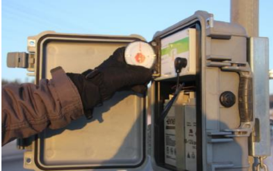
Kuva 15. Kulmamittari asetetaan tukevasti laskentalaitteen laskimeen. Kulmamittarin avustuksella on helppo löytää 90 asteen kulma.
