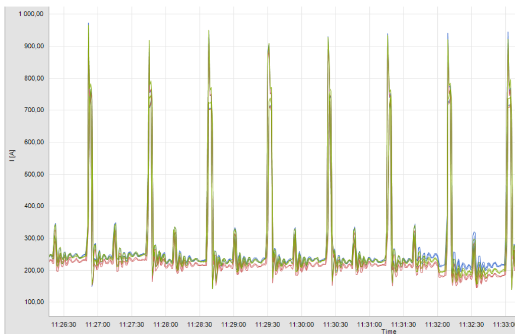
Kuva 23. Pääkeskus 2. Yliaaltopitoisen verkon virtakäyrät L1, L2 ja L3.
