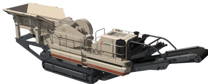
Kuva 2 LT116 tela-alustainen kivenmurskauslaitos leukamurskaimella. (LT116(S) ProductPresentation – powerpoint-esitys, Metso Minerals Oy)
