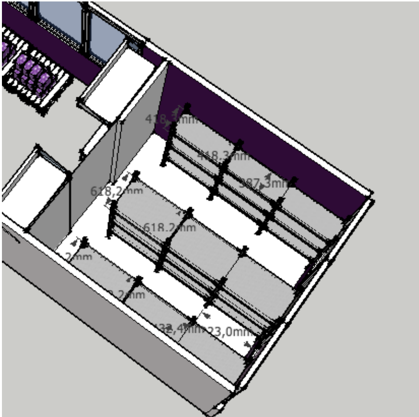
Kuva 60. Myymälän takaosaan erotettu varastotila, johon pitkältä seinältä puretut hyllyt sijoitettiin.
