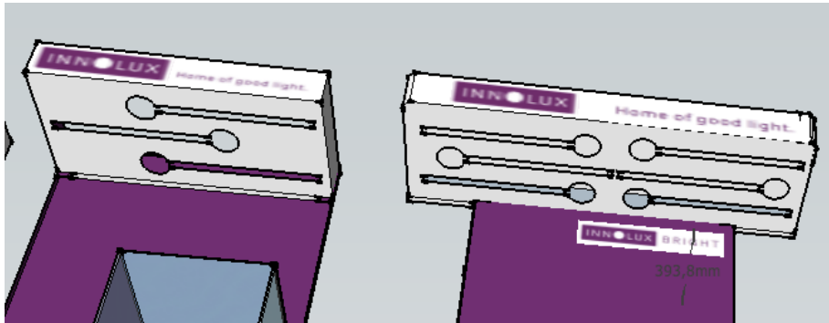
Kuva 47. Valaisinlippojen valaisimien kiinnitykseen tarkoitettujen kourujen vaihtoehtoisia toteuttamistapoja: isosta kohdasta saa sisään sokeripalan ja ylimääräisen johdon. Ohuempi kohta kourua taas on vain sähköjohdon paksuinen.
