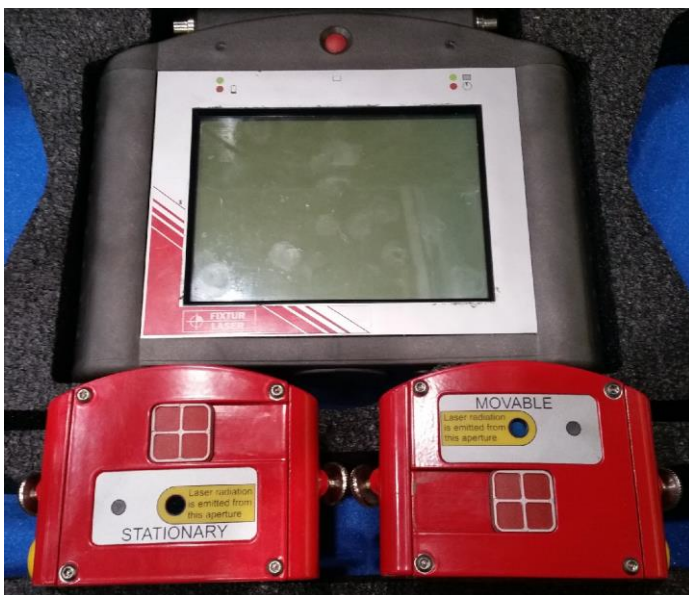
Kuva 9. Päätevastaanotin ja TD-yksiköt.
