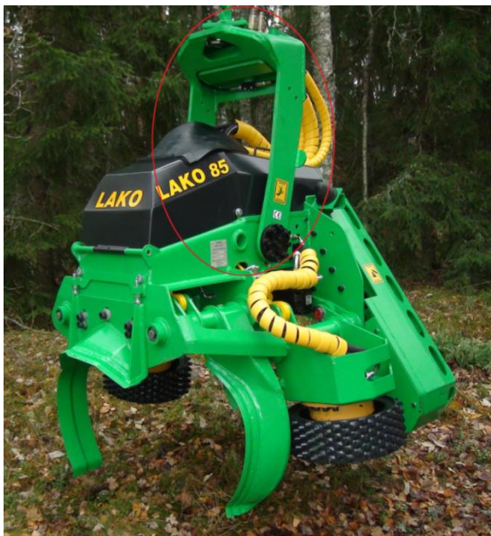
Kuva 1. LAKO 85-harvesteripää vakiokallistimella (kallistinmoduuli ympyröity)
