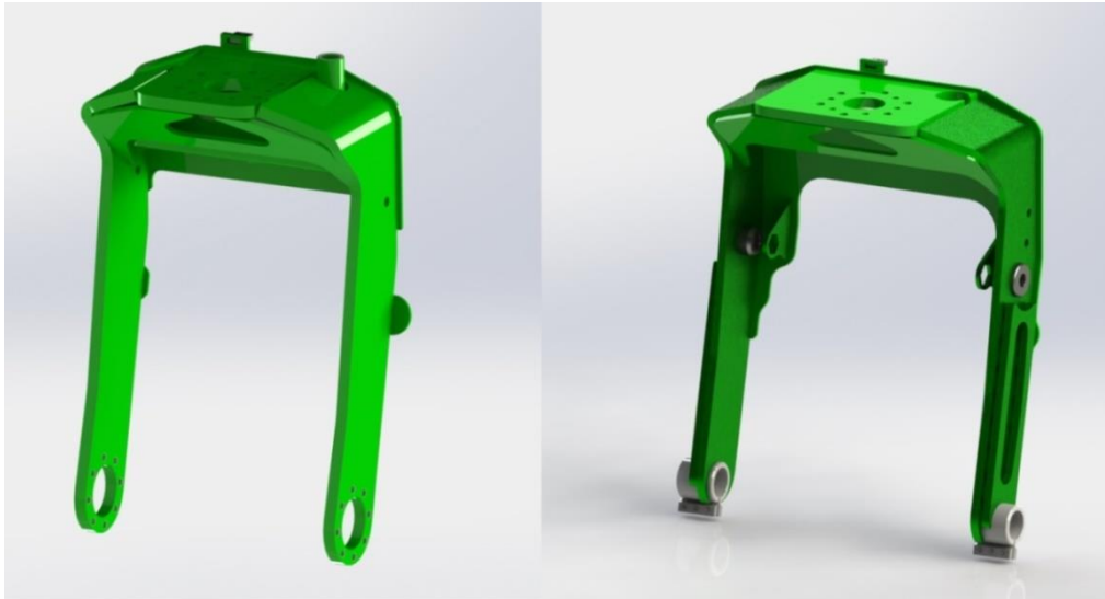
Kuva 10. Vakiokallistimen kaari (vasen) ja uuden kallistimen kaari (oikea)
