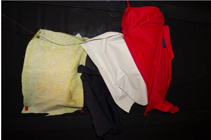
Kuva 12. Materiaaleissa ei ollut merkittäviä jälkiä kipinäsuihkun (nro 12: 10s 3m Stage Fountain) jälkeen.
