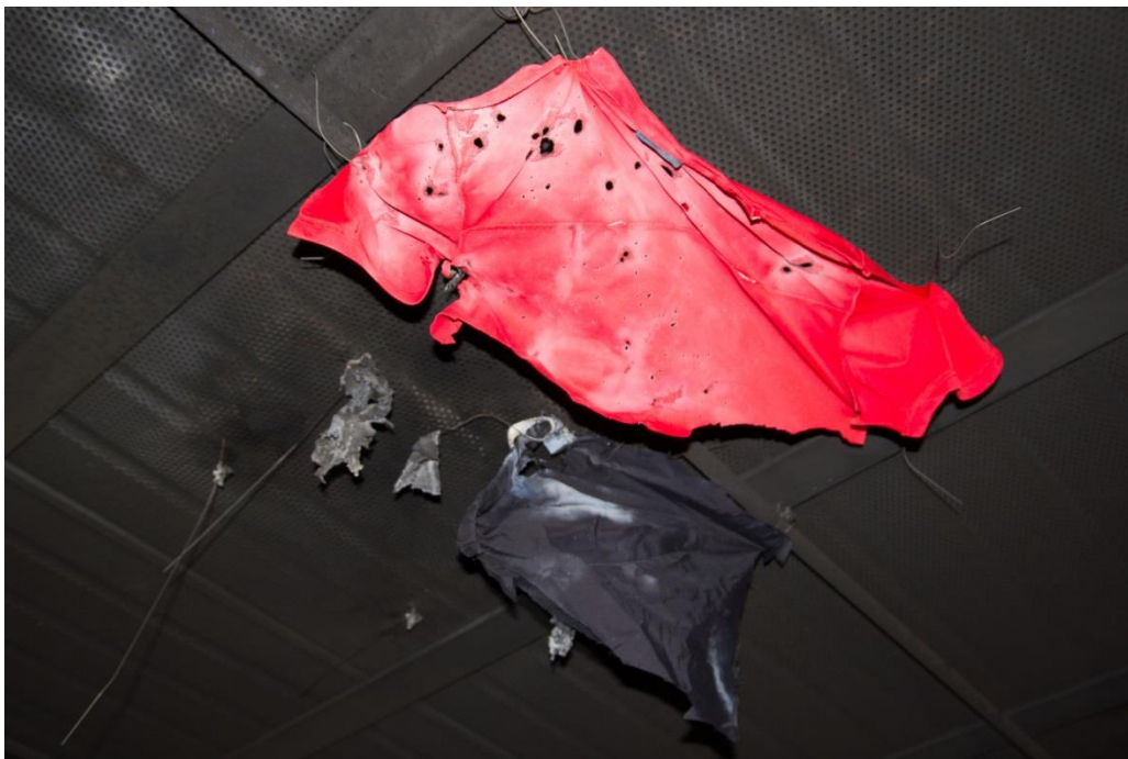
Kuva 13. Lavamiinan (nro 4: 8m stage mine red) aiheuttamia syttymiä. Puuvillakangas ja paperi paloivat kokonaan pois.
