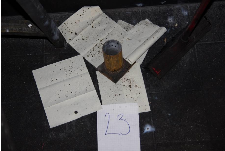
Kuva 7. Kipinöiden aiheuttamia jälkiä käsipyyhepaperieissa
