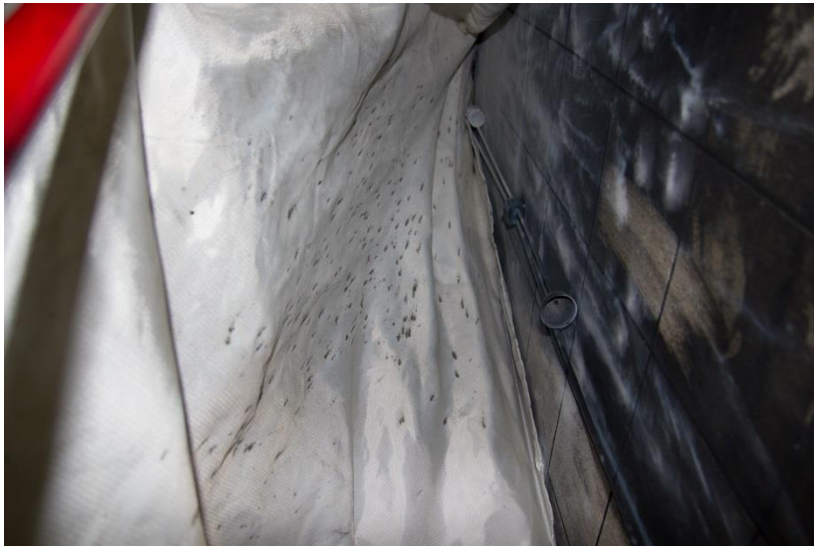
Kuva 5. Kaasumittalaitteiston keräysputkisto seinällä ja polttokokeiden jälkiä
