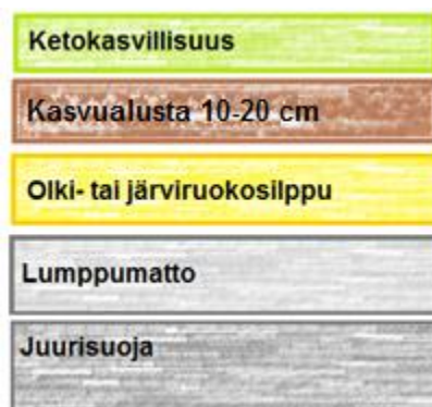
KUVIO 3. Esimerkki viherkaton rakennekerroksista Laurila ym. 2014 mukaan.
