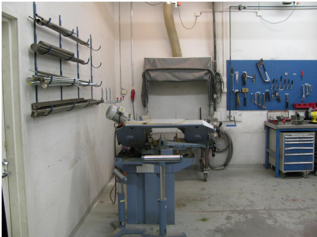
Kuva 31. Huone muutettuna metallikopiksi. Seinustalle asennettiin koukut pitkien metallitankojen ja putkien säilyttämiseksi. Kuvassa etualalla metallisaha. (Lepistö 12/2014)
