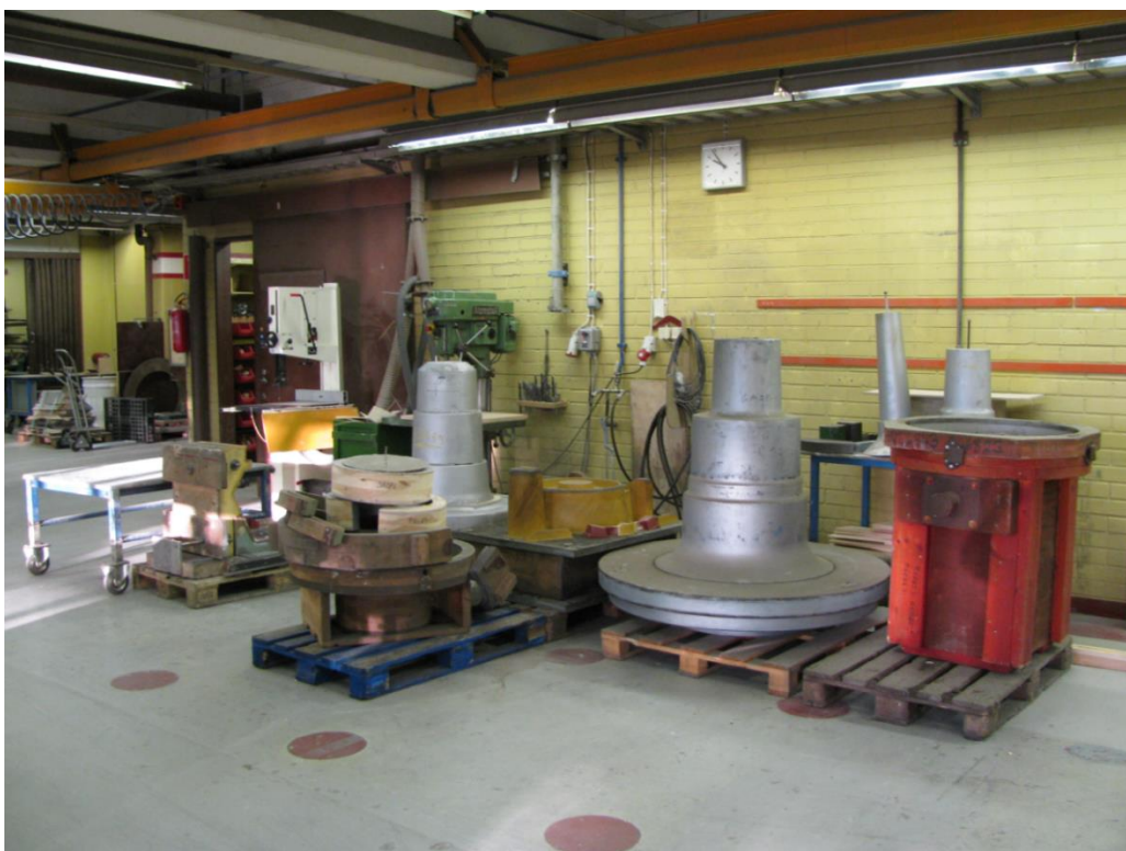
KUVA 9. Valumalleja varastoitiin malliverstaalla siellä, missä tilaa oli. (Lepistö 09/2014)
