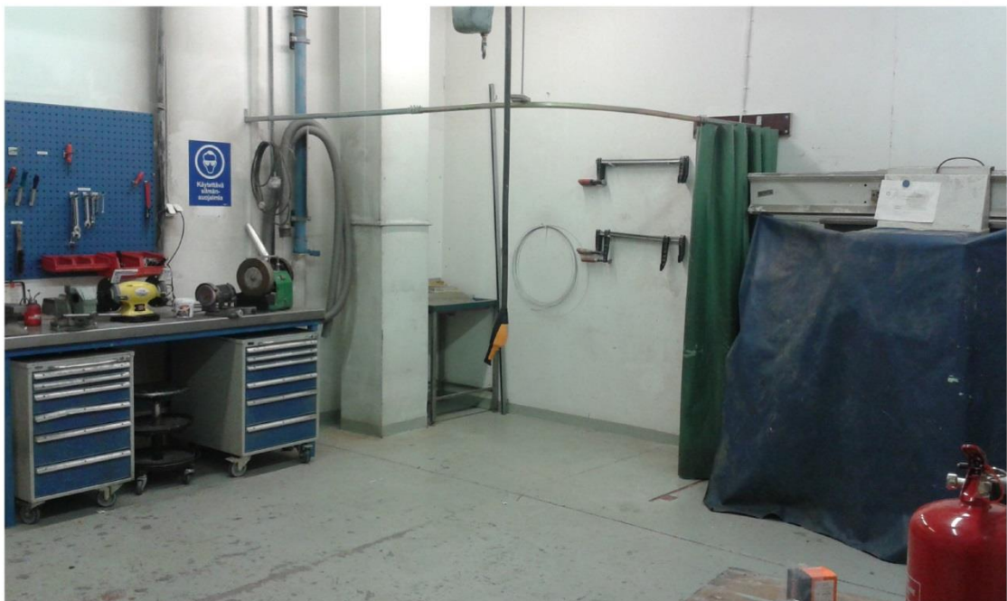
Kuva 33. Huone muutettuna metallikopiksi. Huoneesta hävitettiin palavat materiaalit kuten puiset kaapistot, lämpökoppi sekä puiset pöydät. Metalliselle työpöydälle tuotiin tahkot, uusi smirkeli sekä lasin. Seinälle asennettiin työkalulevy johon ripustettiin ja nimikoitiin metallikopissa tarvittavia työkaluja. Kuvan oikeassa reunassa pajan metallisorvi. (Lepistö 12/2014)
