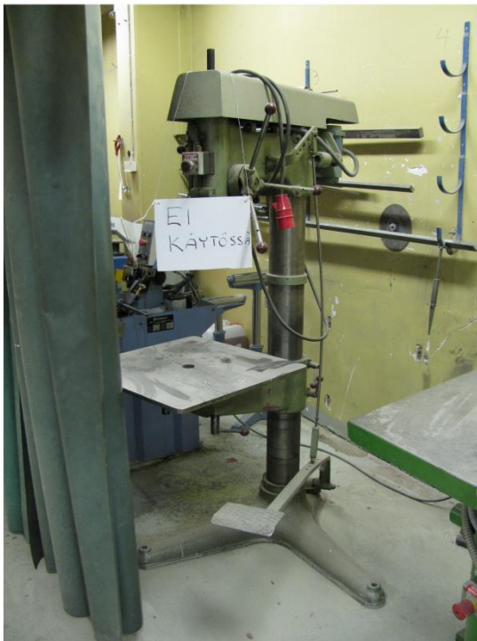
Kuva 35. Konepuolella säilytetty pylväsporakone. Kone oli tarkoitus siirtää pajalta valimon varastoihin odottamaan päätöstä sen kohtalosta. Pylväsporakone oli poissa käytöstä puutteellisten suojainten takia. (Lepistö 10/2014)
