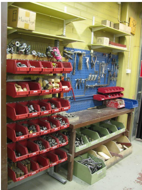
Kuva 29. Muovikopin seinustan hyllyköihin järjesteltiin ja nimikoitiin paikat yleisessä käytössä oleville työkaluille sekä automaatin keernalaatikoiden tarvikkeille. (Lepistö 12/2014)
