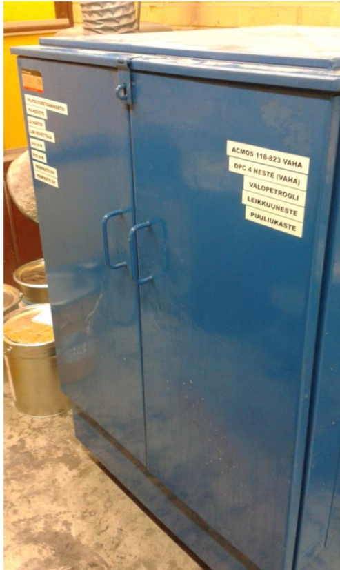
Kuva 28. Muovikoppiin tuotuun kemikaalikaappiin järjesteltiin kaikki pajalla käytetyt muovit sekä muovitöissä käytetyt vahat. Metallikopin läheisyyden vuoksi kaapissa säilytetään myös leikkuunestettä sekä teroitusöljyä. (Lepistö 12/2014, Lepistö 12/2014)
