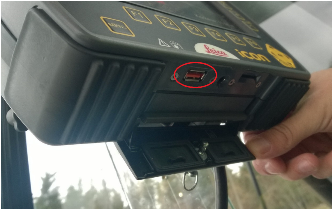
Kuva 13. Hytin näytössä oleva USB-portti, jonka kautta on mahdollista siirtää suunnitelma järjestelmään
