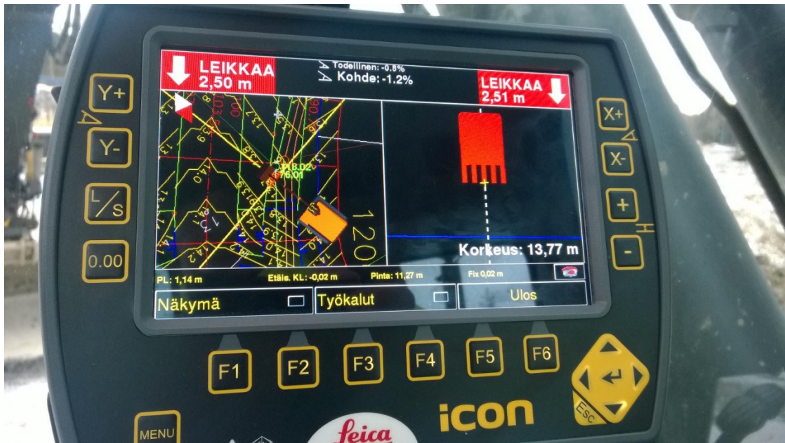
Kuva 3. Näkymä 3D-järjestelmän kuljettajan hytissä sijaitsevasta näytöstä. Kuvaushetkellä kuljettaja kaivoi sadevesilinjaa.
