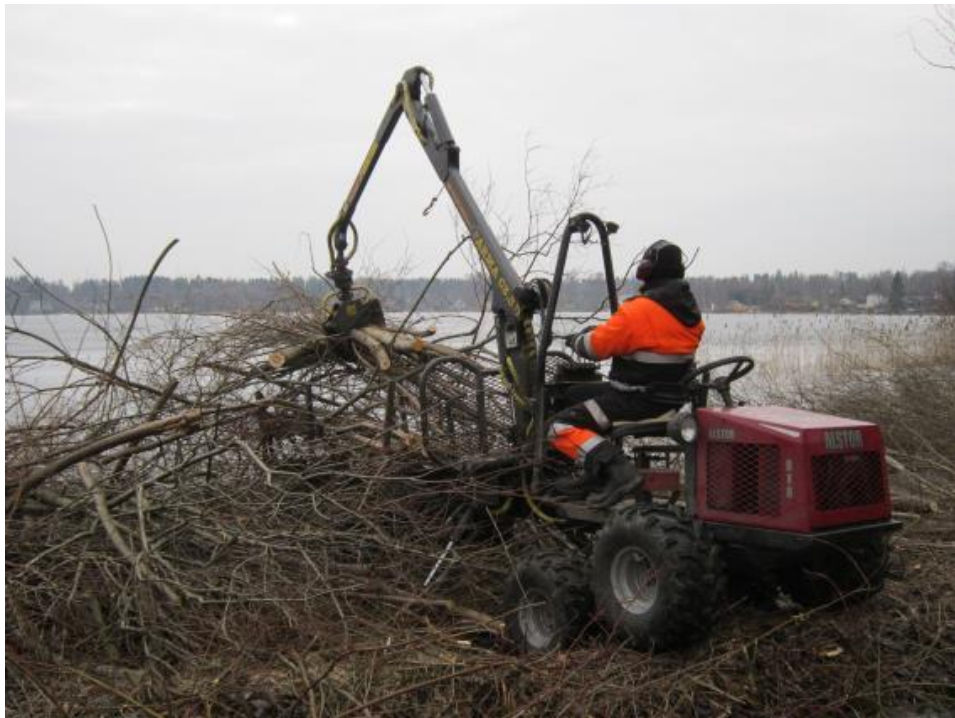
Kuva 28. Alstor soveltuu hyvin lähikuljetukseen kantavuudelta ja maastoltaan haasteellisissa kohteissa. Kuvan Alstor on kuormaamassa energiapuuta järven rannassa.
