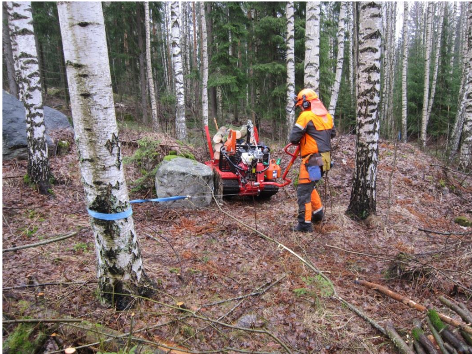
Kuva 33. Koneen hyvä käytettävyys on merkittävä osa miellyttävää ja tehokasta työskentelyä. Käyttäjän perehtyneisyys laitteen ominaisuuksiin takaa laitteen tarkoituksen mukaisen käytön. Kuvassa kiinni juuttunut rautahepo irrotetaan vinnin avulla.
