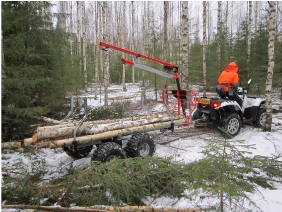
Kuva 21. Mönkijä toimii kuormatraktorina, kun se varustellaan metsäperävaunulla. Kuvan metsäperävaunu on varusteltu vaijerinostimella.
