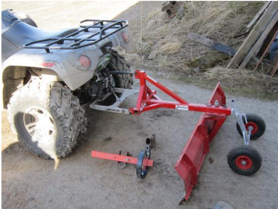
Kuva 22. Mönkijä voidaan varustella lanalla, jota voidaan hyödyntää metsäteiden ylläpidossa. Kuvan lanaan on itse rakennettu metsän laikutukseen sopivat lisäterät. Lisäterä on maassa lanasta irrallaan oleva rauta.
