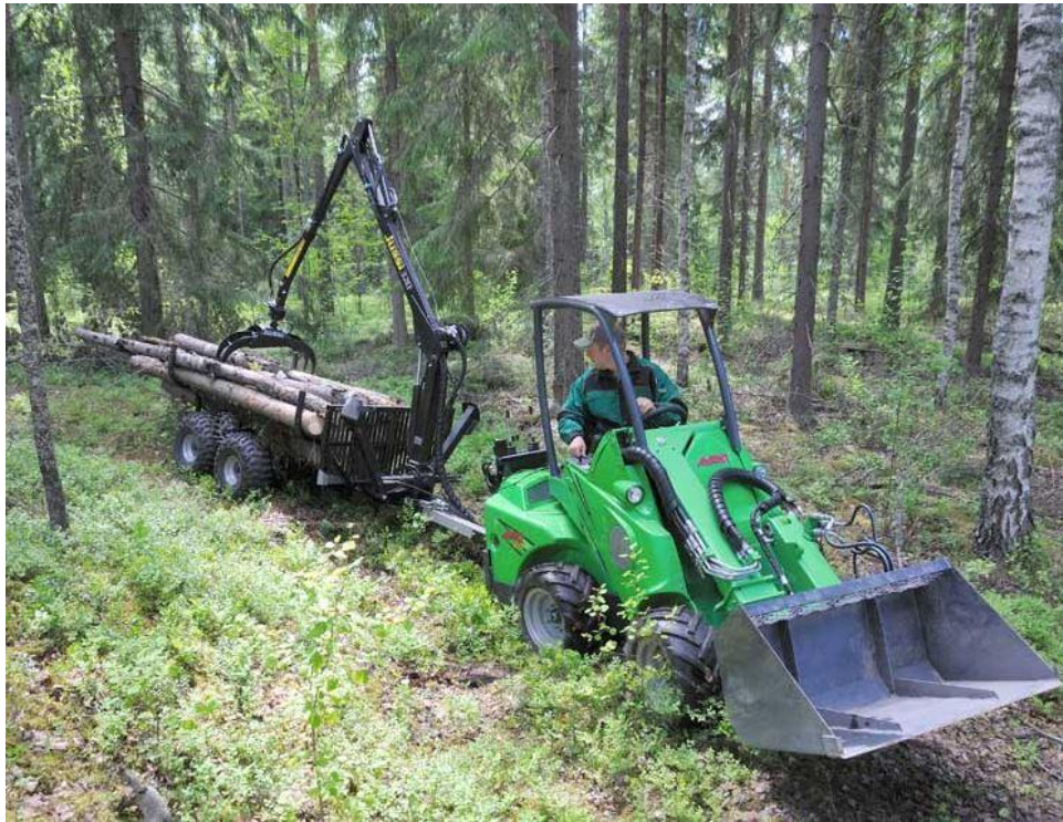
Kuva 26. Avant on monikäyttöinen työkone, johon on asennettavissa myös metsäperävaunu (Avant 2014).
