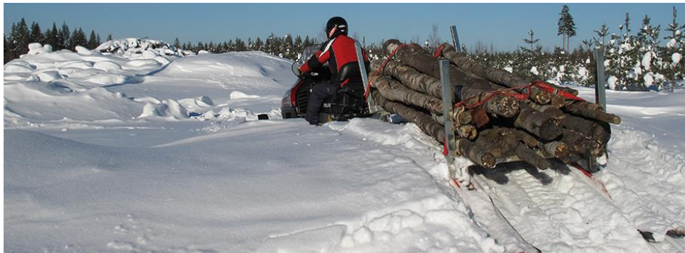
Kuva 23. Moottorikelkka soveltuu paksuimman lumen aikana rankojen tai kuitupuun kuljettamiseen (Ultratec 2014).
