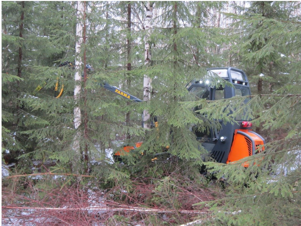
Kuva 35. Tehojätkä ei tarvitse ennakkoraivausta, koska näkyväisyys koneen ohjaamosta riittää puomin lyhyiden vuoksi.
