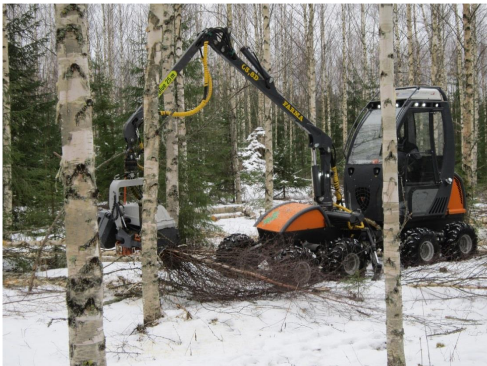
Kuva 31. Tehojätkä on pienmetsäkone, joka muuntuu tarvittaessa eri-ikäisten taimikoiden hoitoon sekä nuorten metsien harvennushakkuuseen.
