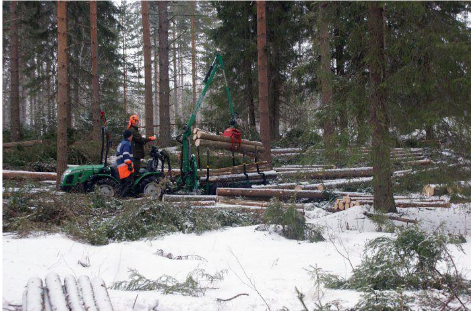
Kuva 25. Pienoistraktorit soveltuvat myös harvennushakkuiden lähikuljetukseen (Ferrariagri 2014).
