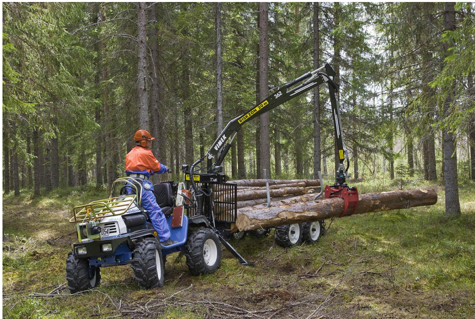
Kuva 32. Vimek Minimaster on metsäkäyttöä varten rakennettu mönkijän ja metsäpe- rävaunun yhdistelmä (PowerForest 2014).
