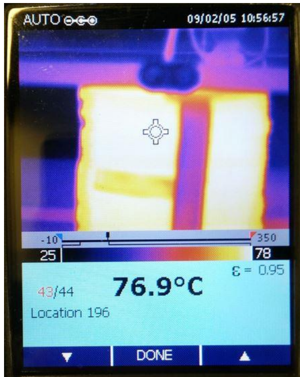
KUVA 26 50 \mu H kelan pintalämpötila ajanhetkellä 75min
