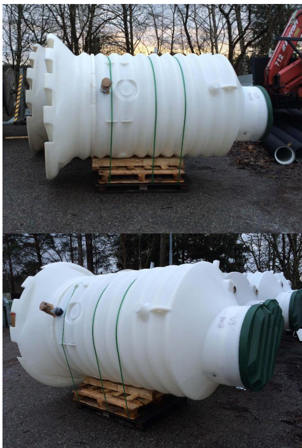
Figur 7. Fotograf på en mätbrunn. Det är endast den smala delen med det gröna locket som blir ovanför marken, resten grävs ner. Rasmus Lönnberg 2014.
