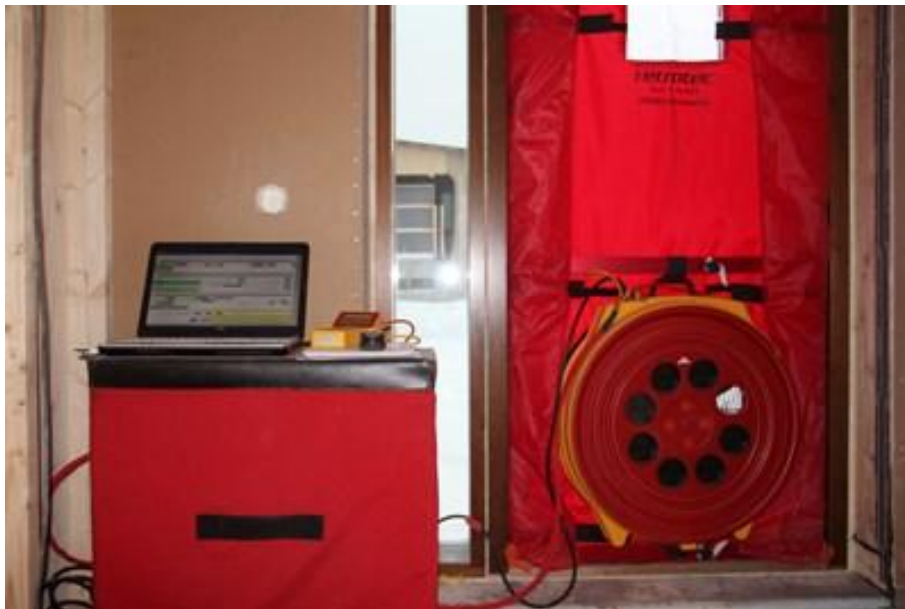
Kuva 4. Painekekeessa käytettävä mittauslaitteisto. (Ilmatiiveyden mittaaminen.)
