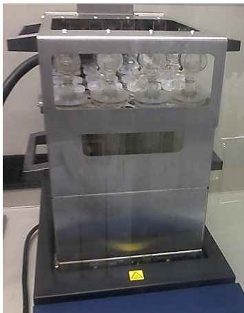
KUVA 6. Kokonaistypen määrittämiseen käytettävä polttolaitteisto vetokaapissa (Kuva: Sanna Harju 2015)
