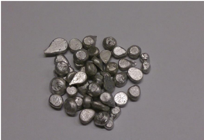
Kuva 22. Alumiinigranulaatit ennen kylpyyn lisäämistä.
