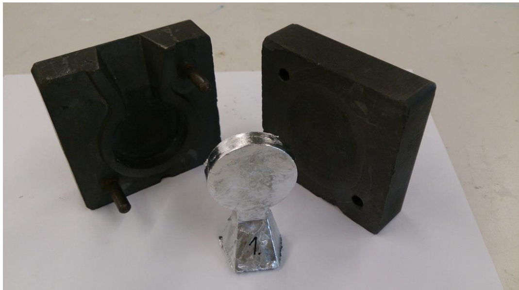
Kuva 26. Sinkkikylvystä valettu näytenappi
