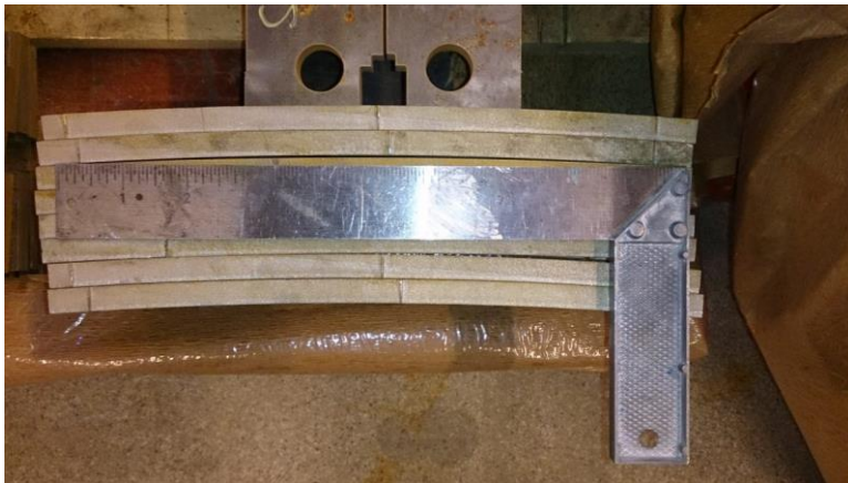
Kuva 23. Kategorian B levyjä, joiden myötölujuus on 500 MPa.
