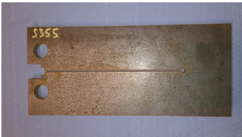
Kuva 18. LNT-koelevy S355J2 teräksestä leikattuna mittapiirrosten mukaisesti.
