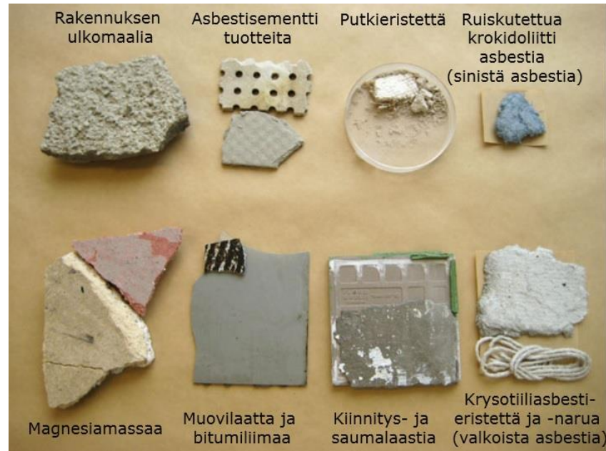
Kuva 5. Asbestia sisältäviä materiaaleja (Oksa ym.)
