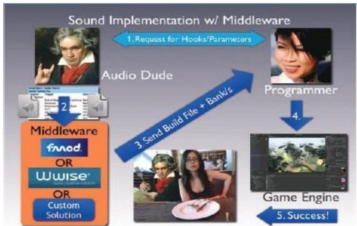
Kuva 8. Kuvio työprosessista väliohjelmistoja käytettäessä. (Horowitz, Looney 2014)
