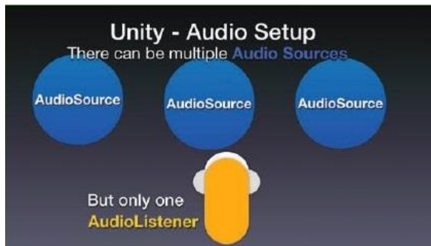
Kuva 6. Unityn äänijärjestelmän toimintaperiaate (Horowitz, Looney 2014)
