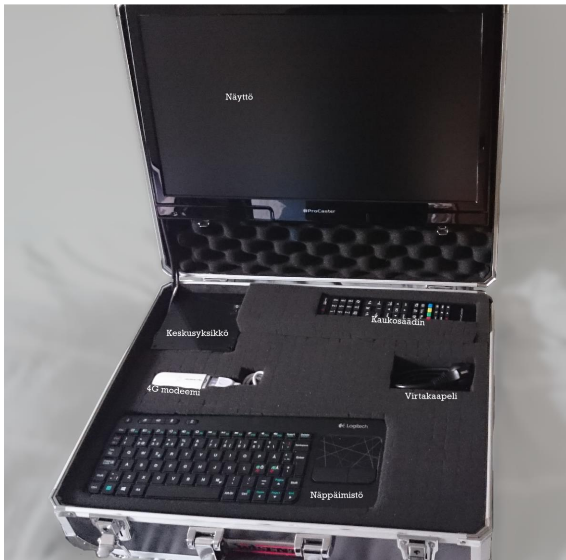
Kuva 2. Lennättäjälle videon ja lentotiedot näyttävä maa-asema osineen.
