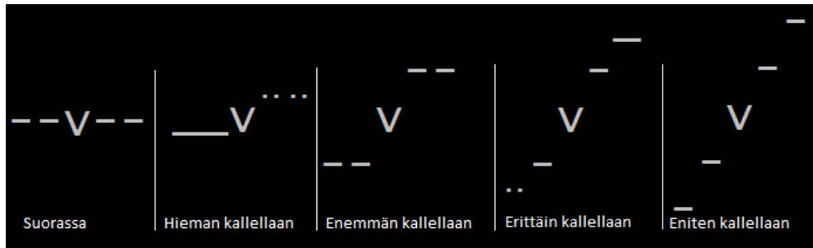
Kuva 3. Terminaalissa esitetty lentokoneen kallistus suorasta asennosta ääriasentoon vasemmalle.
