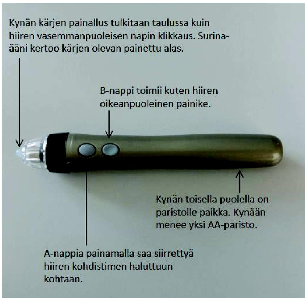
Kuva 10. CleverBoard 3:n interaktiivisen kynän osat ja niiden tarkoitukset [22].
