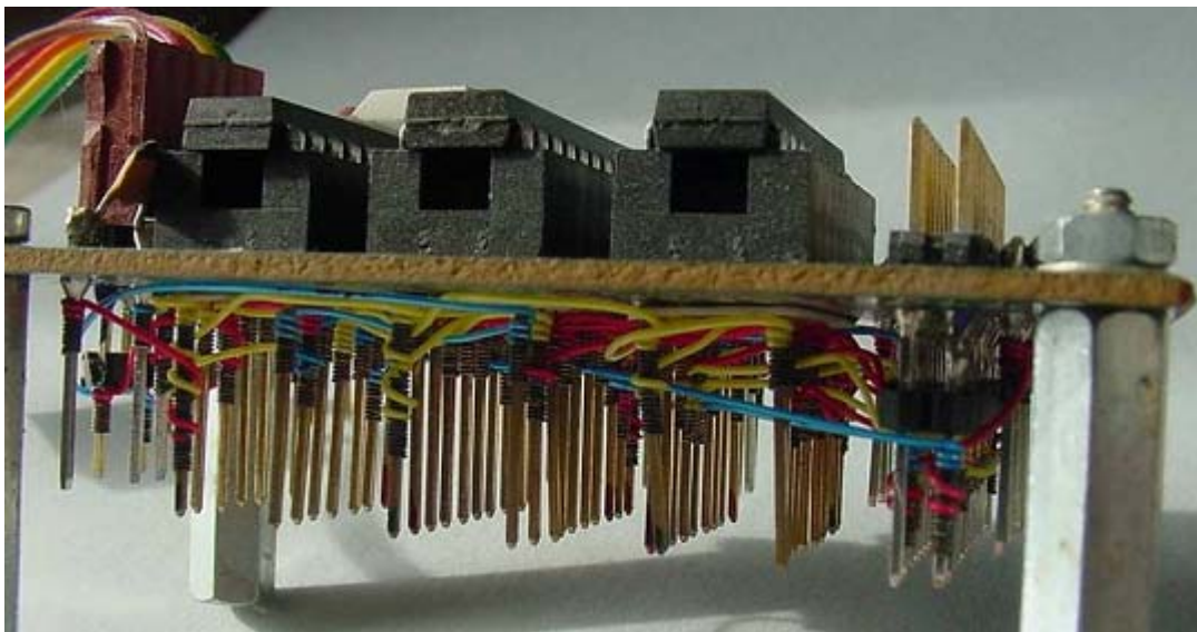
Kuvio 13. Wire-wrap-tekniikalla valmistettu kytkentä /3/
