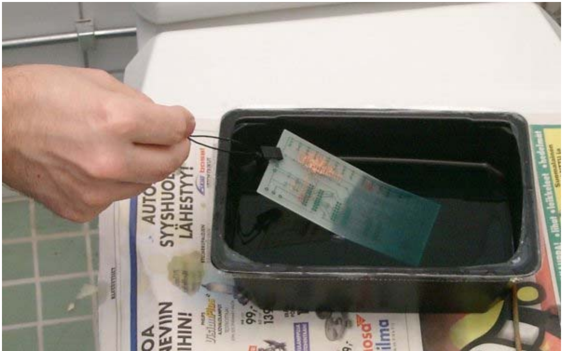
Kuvio 16. Piirilevyn kehitysvaihe, jossa piirilevyltä poistetaan ylimääräinen lakkakerros /8/
