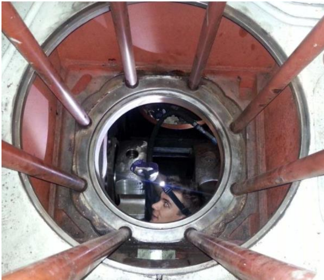
Kuva 15 Lohkon tiiviste- ja O-rengaspinnat hiottu puhtaaksi
