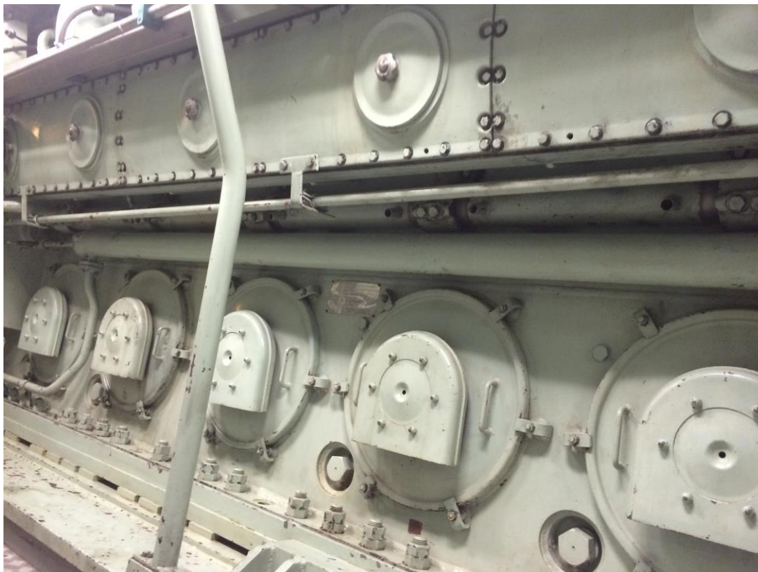
Kuva 13 Vesiputket on poistettava ennen vesimansetin irrotusta
