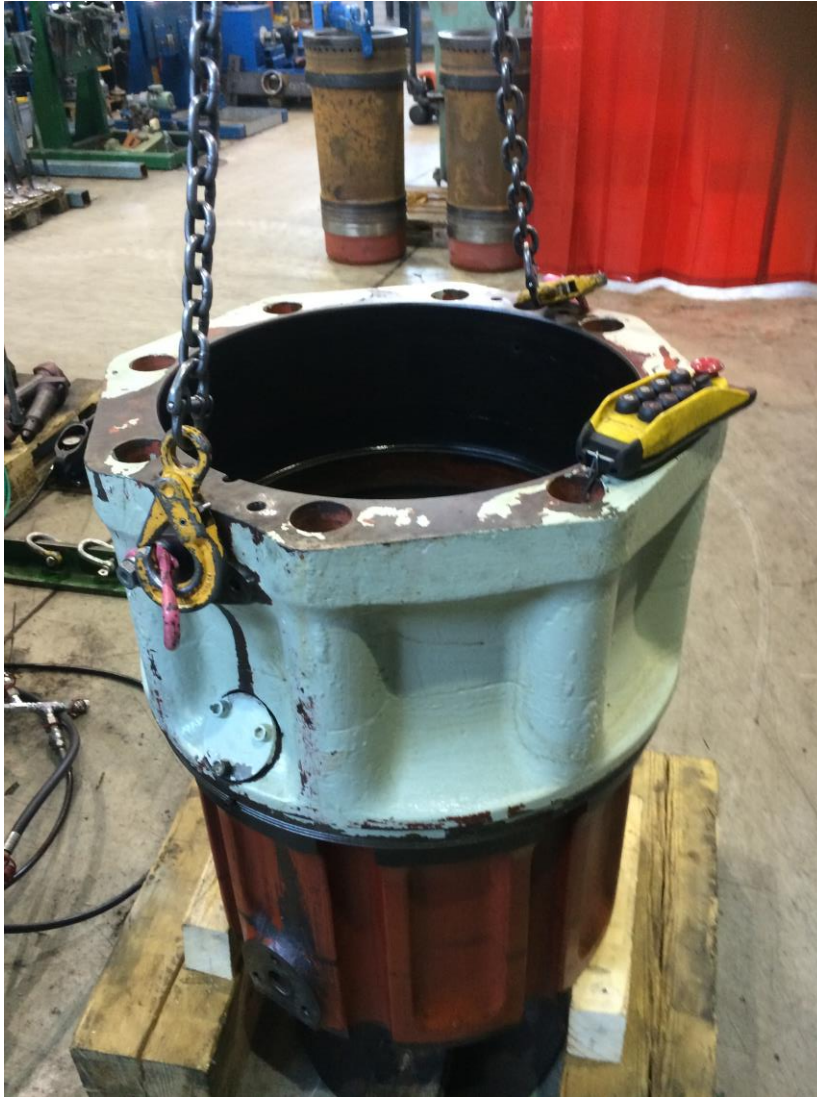
Kuva 14 Edessä vesimansetti takana sylinteriputki
