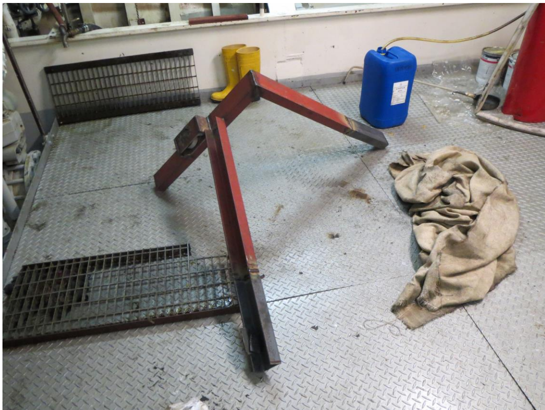
Kuva 45 Tukirauta potkuriakselin pitkittäissiirtymisen estämiseksi
