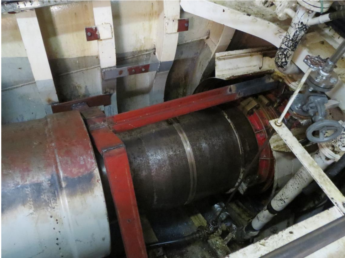
Kuva 44 Tukirauta potkuriakselin pitkittäissiirtymisen estämiseksi
