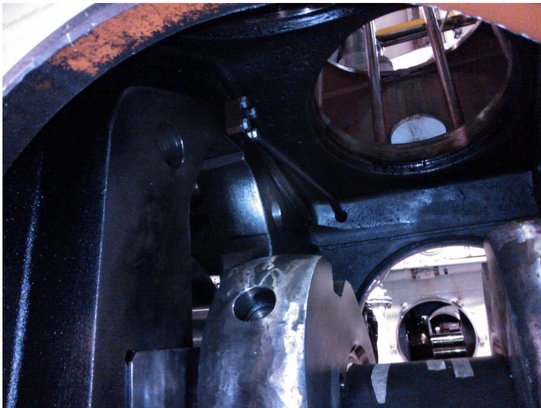
Kuva 19 Raamilaakerin kansi ja paineruuvi oli poistettu
