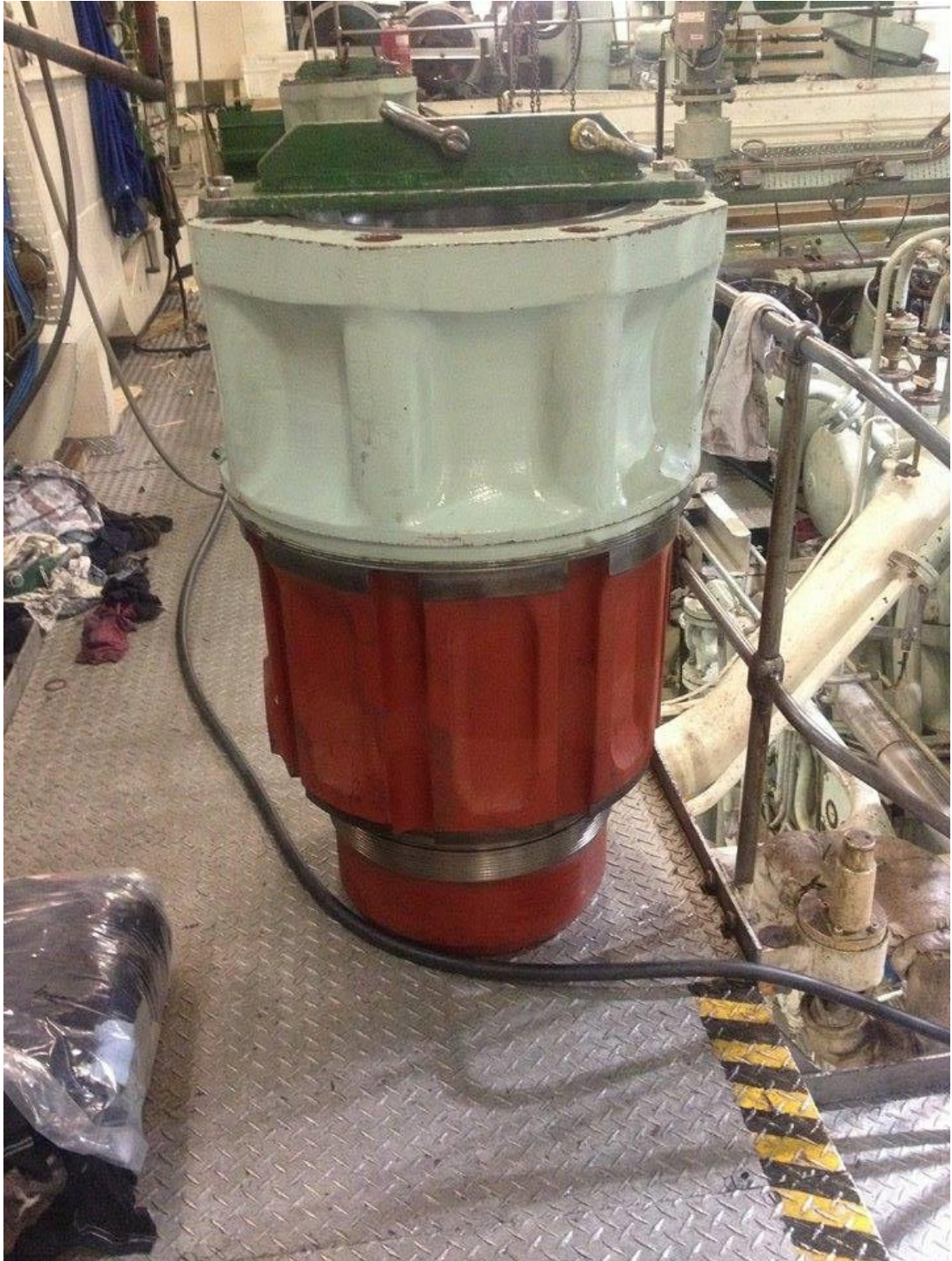
Kuva 54 Sylinteriputki, vesimansetti ja asennusrauta
