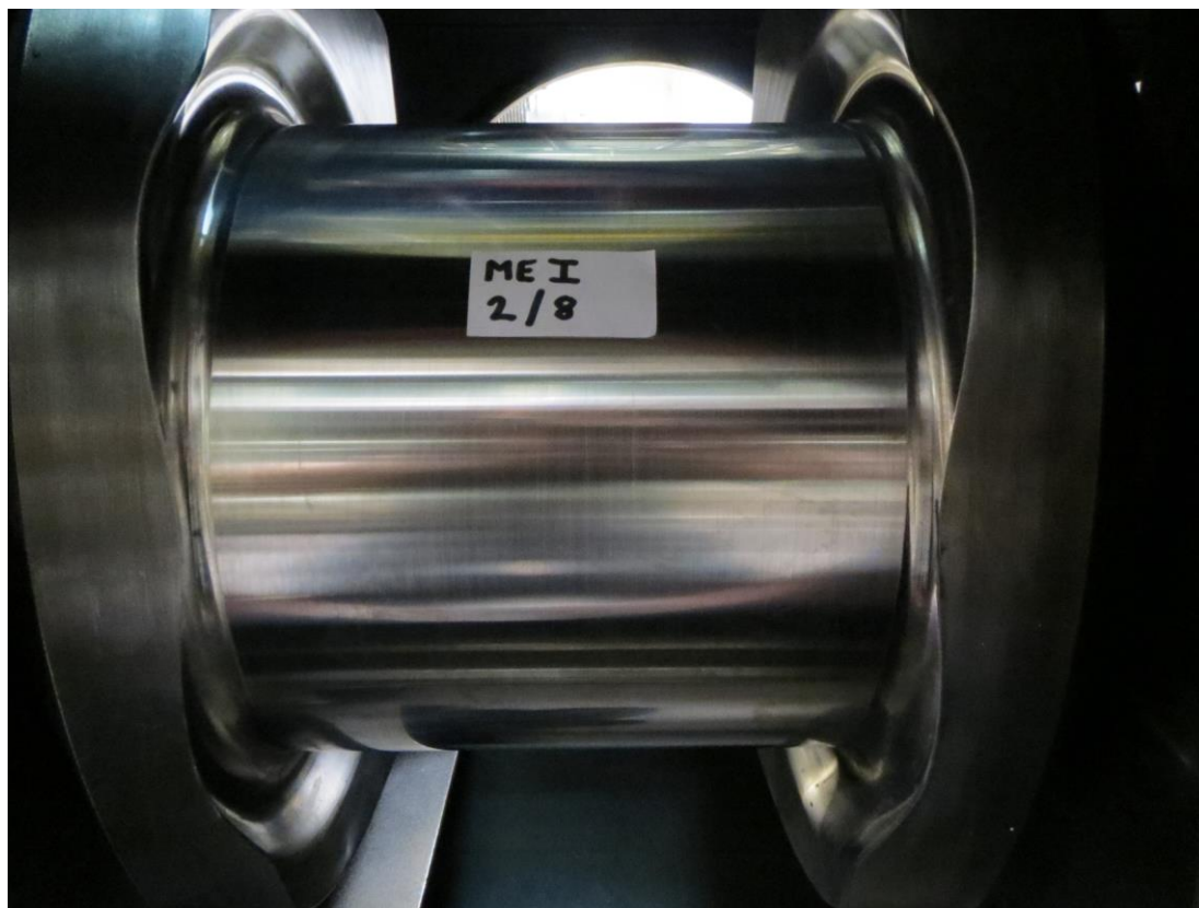
Kuva 22 Kiertokangen laakerikaulat hiottiin
