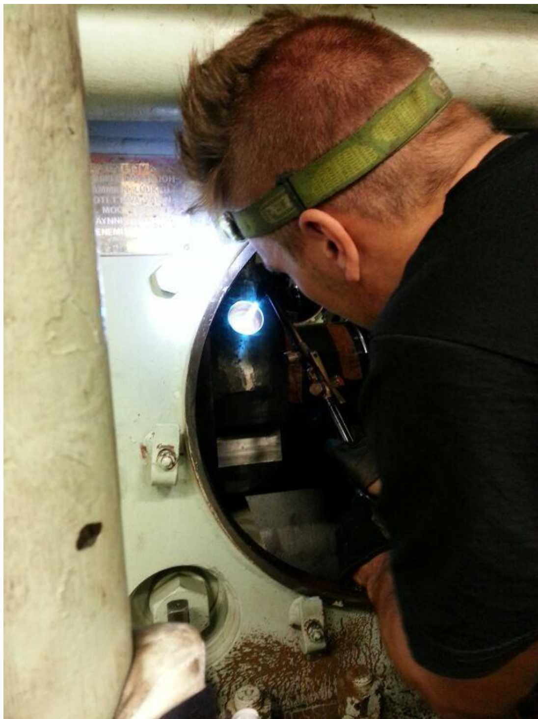
Kuva 18 Kampiakselin öljyporauksen lämmittäminen
