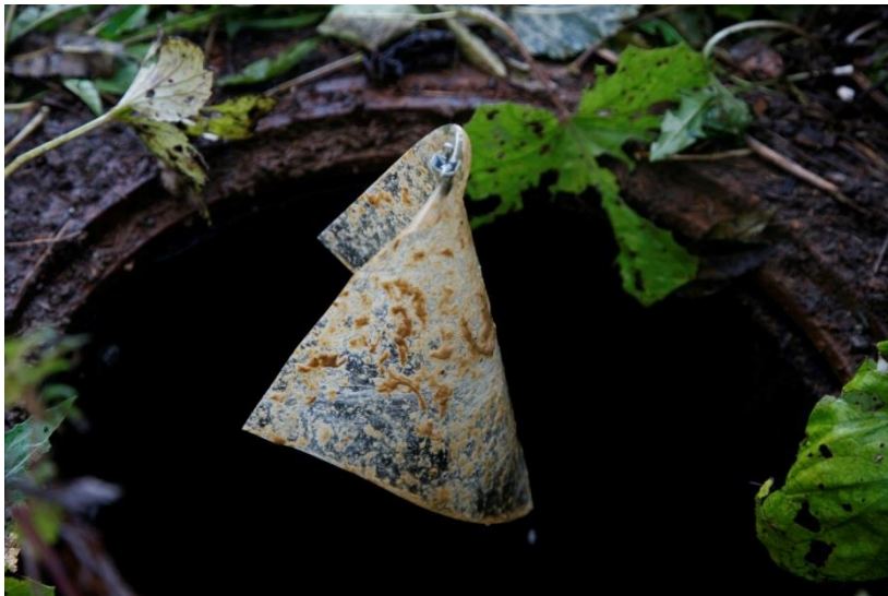
Kuva 13. Öljynäytteen otto ETFE-verkolla.
