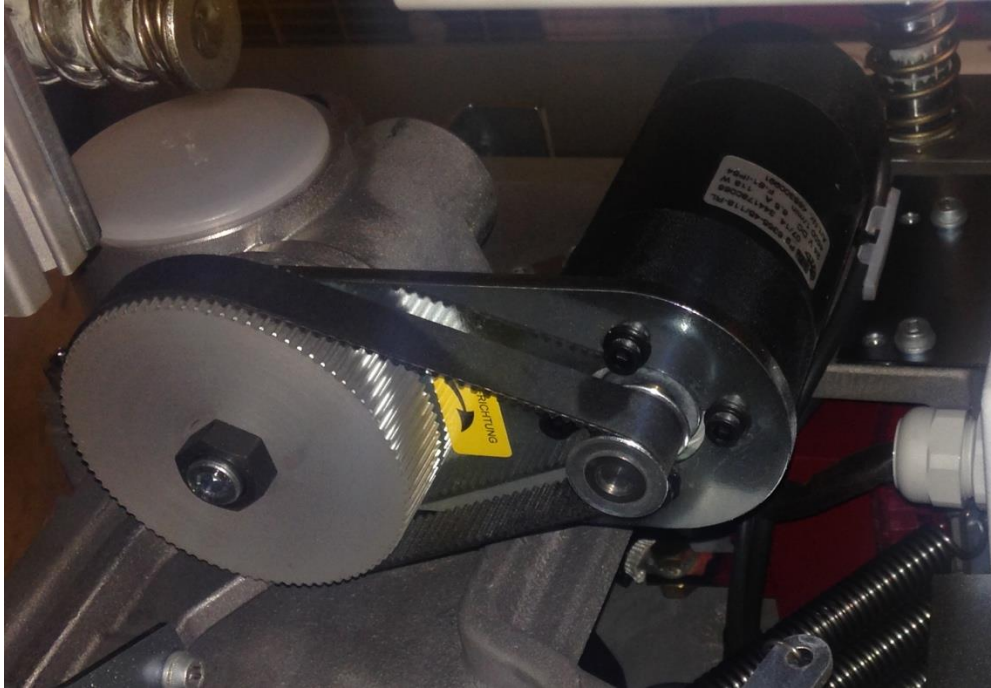
Kuva 10. Syöttöpään rullia pyöritetään servomootoreilla.
