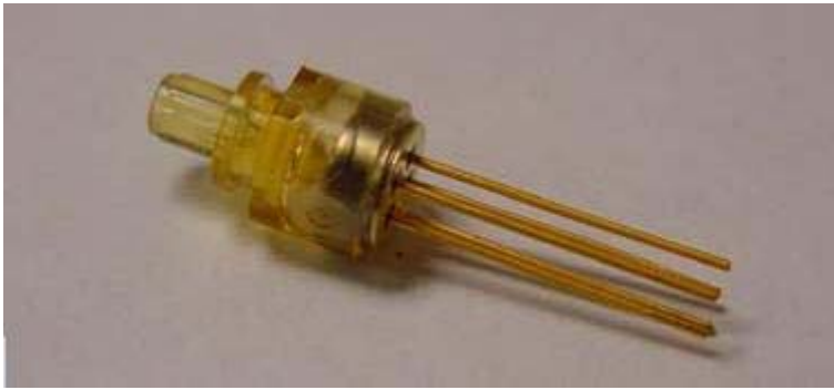
Kuva 6.1 Tämä PIN-valodiodin toimii 155 Mbit/s nopeudesta aina 4,25 Gbit/s nopeuksille. [15]
