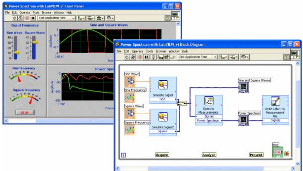
Kuva 7. LabVIEW vasemmalla mittauksia seuraava etupaneeli, eli käyttöliittymä ja oikealla graafista ohjelmakoodia vastaava lohkokaavio. /12/
