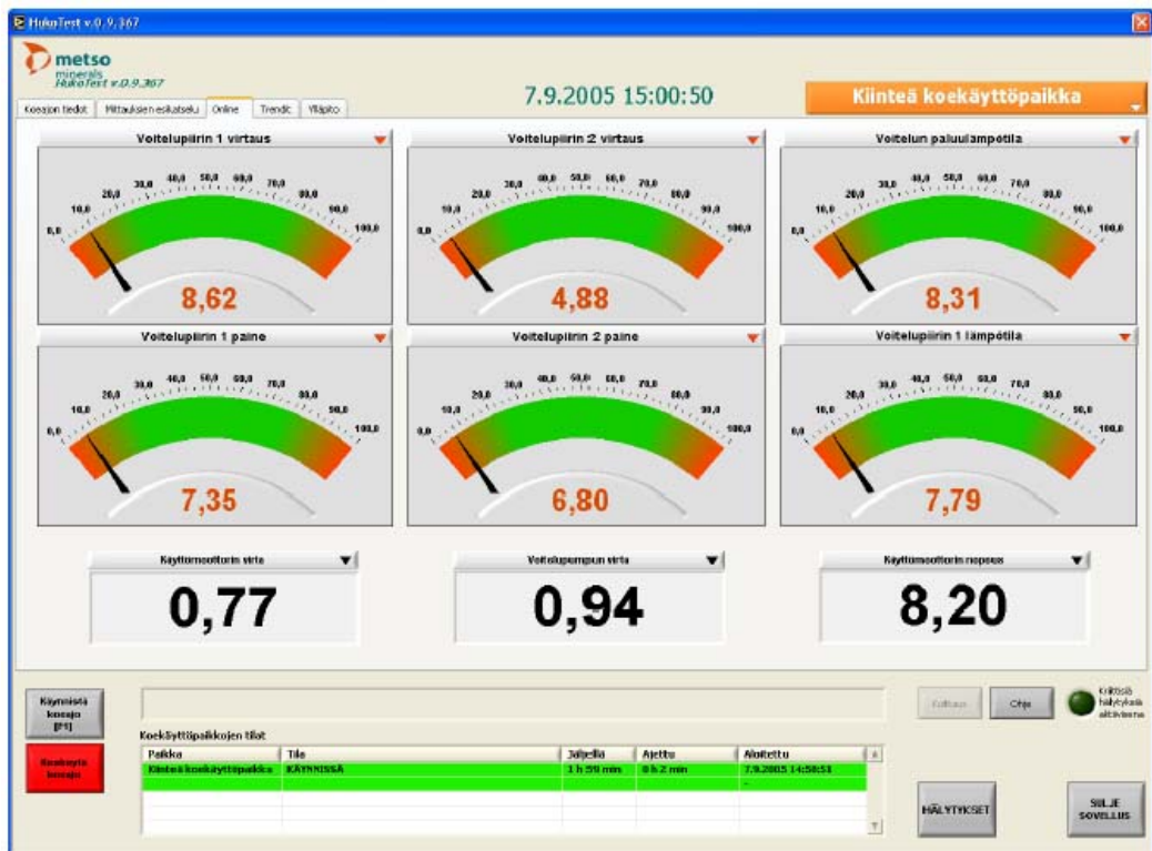
Kuva 8. Metso Mineralsin murskaimen koekäyttöjärjestelmän LabVIEW:lla toteutettu käyttöliittymä ja mittausten seuranta. /13/
