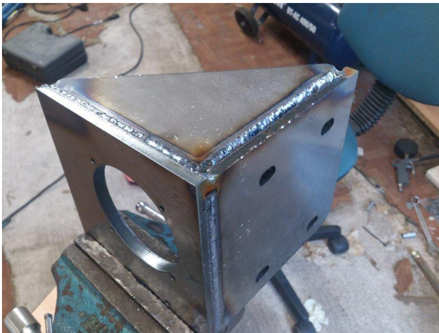
KUVIO 4. X-akselin askelmoottorin kiinnitysrauta hitsattuna.
