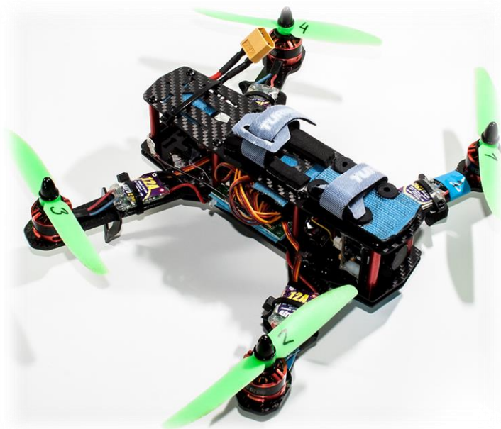
KUVA 1. 250 mm kokoinen neliroottorinen multikopteri
