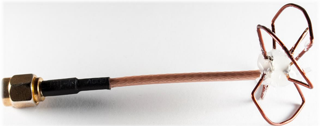
KUVA 30. Omatekoinen Skew planar-antenni
