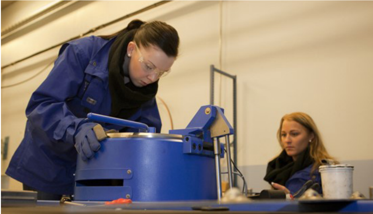
Kuva 3 Ohutlevyn muovattavuuden testausta oppilasprojektissa.
