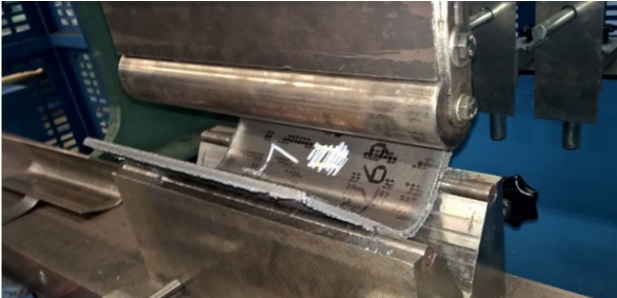
Kuva 5. Työssä käytetty särmäysmenetelmä.
