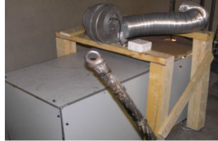
Kuva 3. Konenäköprototyyppi asennettuna kaivoksen nostokoneen köysien valvontaan ja kameran näkemä kuva.
