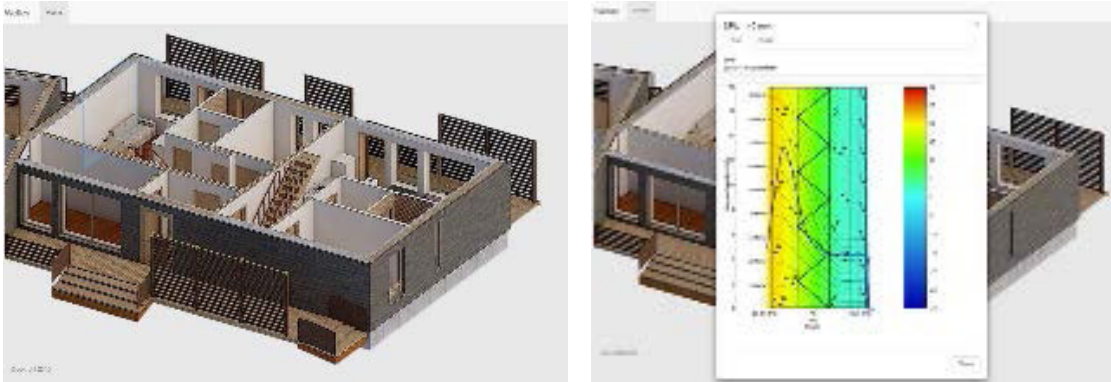
Kuva 2. Käyttöliittymä tulosten käsittelyä ja esittämistä varten (vas.). Rakennuksen isometrisessä projektionäkymästä valitaan tarkasteltava ulkoseinaelementti ja siitä saadaan tarkasteltavaksi tiedot ja mitattu data uuteen ikkunaan (oik.).
