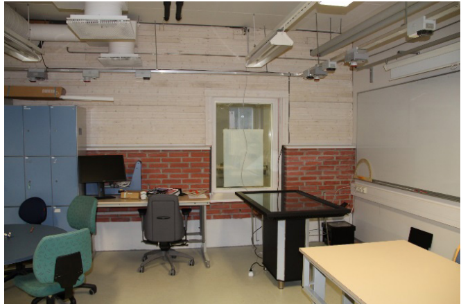
Kuva 1. Tiiveysmittauksen ulkoseinä keskellä rakennuksen sisätiloja. (kuva: K. Ryyänen)
