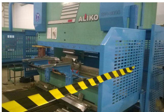
Kuva 1. Särmäystesteissä käytetty Aliko 220-3000 särmäyspuristin.
