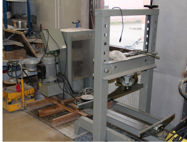
Kuva 3. Betonin koestamisen laitteistoa. (Kuva: K. Ryyänen)
