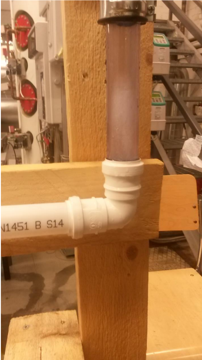
KUVA 11. Viemäriputkessa virtaavan veden aiheuttama padotus
