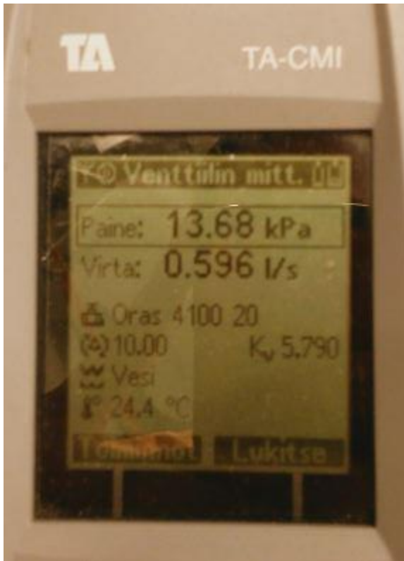
KUVA 9. Vesivirta säädettiin haluttuun arvoon säätämällä veden virtausta sulkuventtiilillä.
