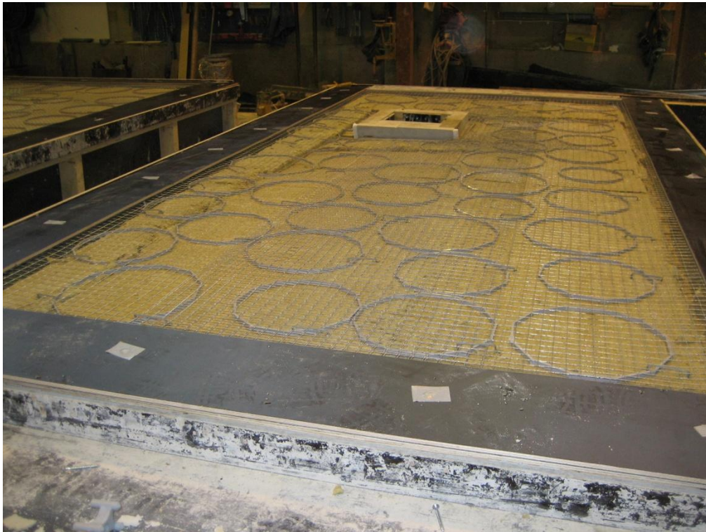
Kuva 2: Valmis elementti rappausvalua varten.
