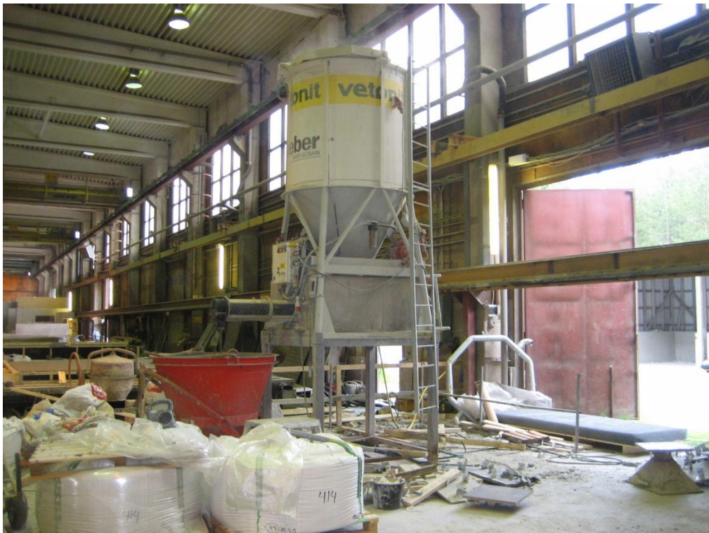
Kuva 6: Laastin valmistukseen käytettävä siilo/ruuvisekoitin yhdistelmä
