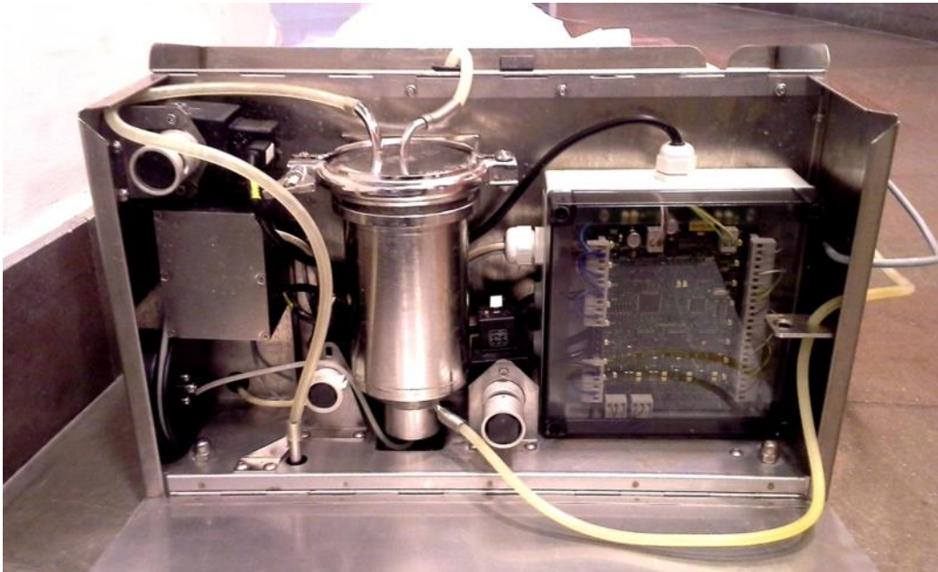
Kuva 6. Maitosäiliö ja säiliön maitoletkut löytyvät ohjausyksikön kannen alta.
