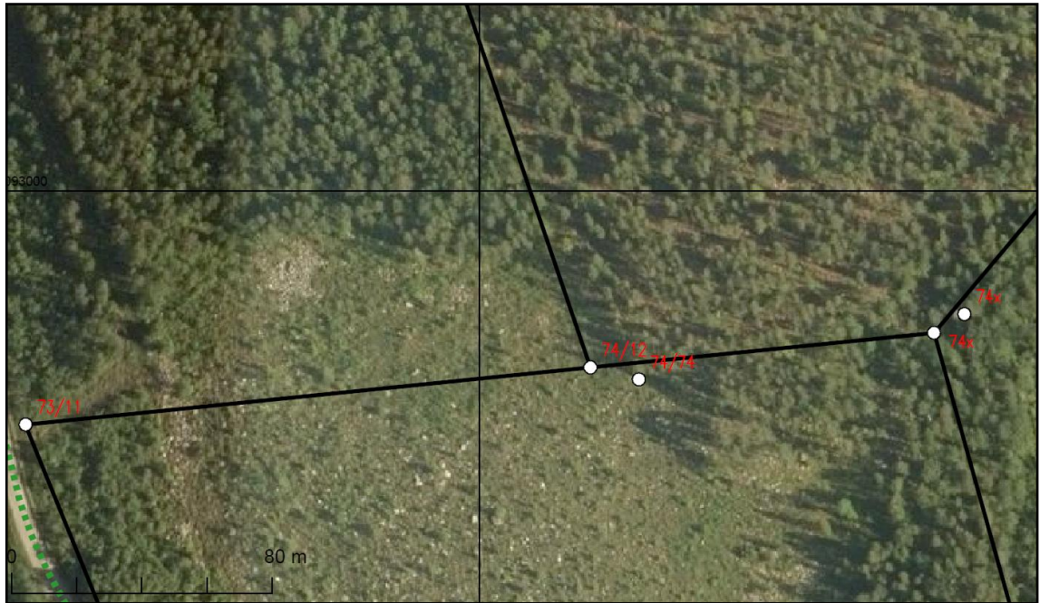
Kuva 6. Kuvassa mitatut pyykki 74 ja 74x ovat irrallaan rajaviivoista. 74x oikealla ja 74 keskellä.
