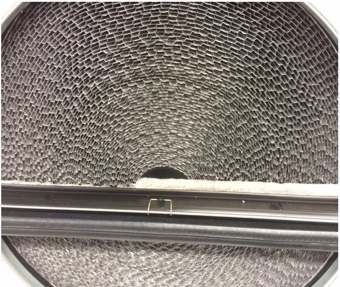
Kuva 10. Valmistettu suorakaideprofiilinen lämmönsiirrin.
