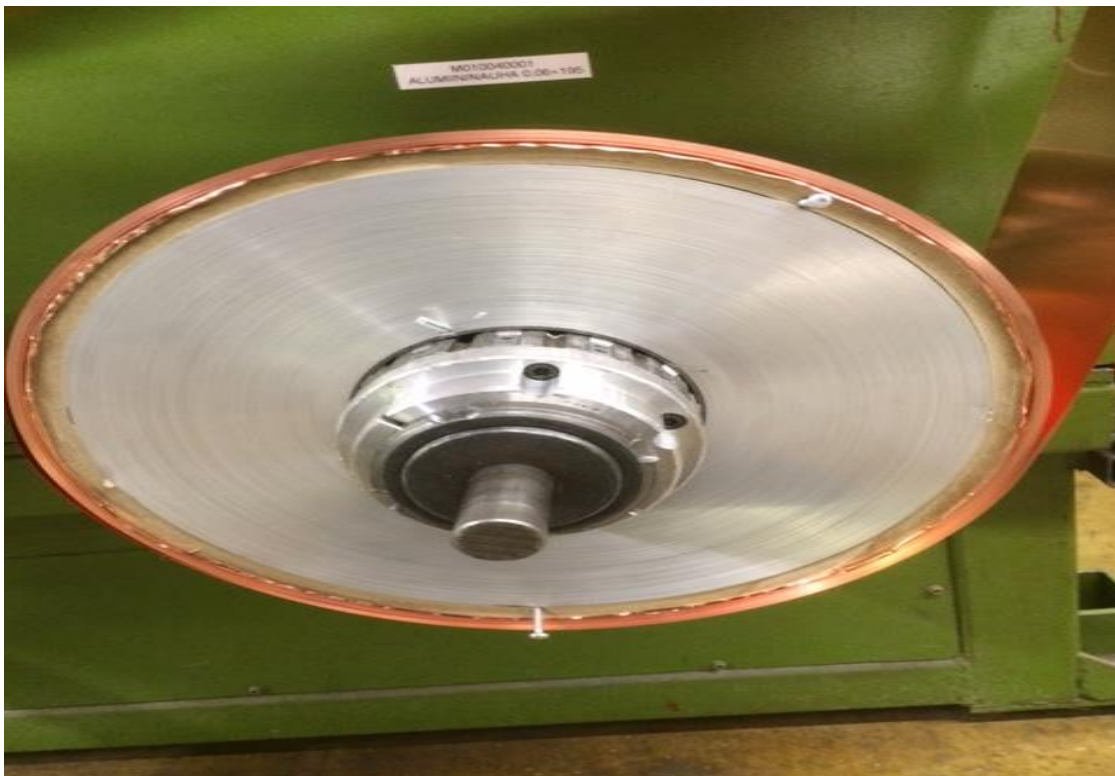
Kuva 11. Rypytettävä kupariraina kiinnitettiin ruuveilla alumiinirullan päälle kuparikennon valmistamiseksi.
