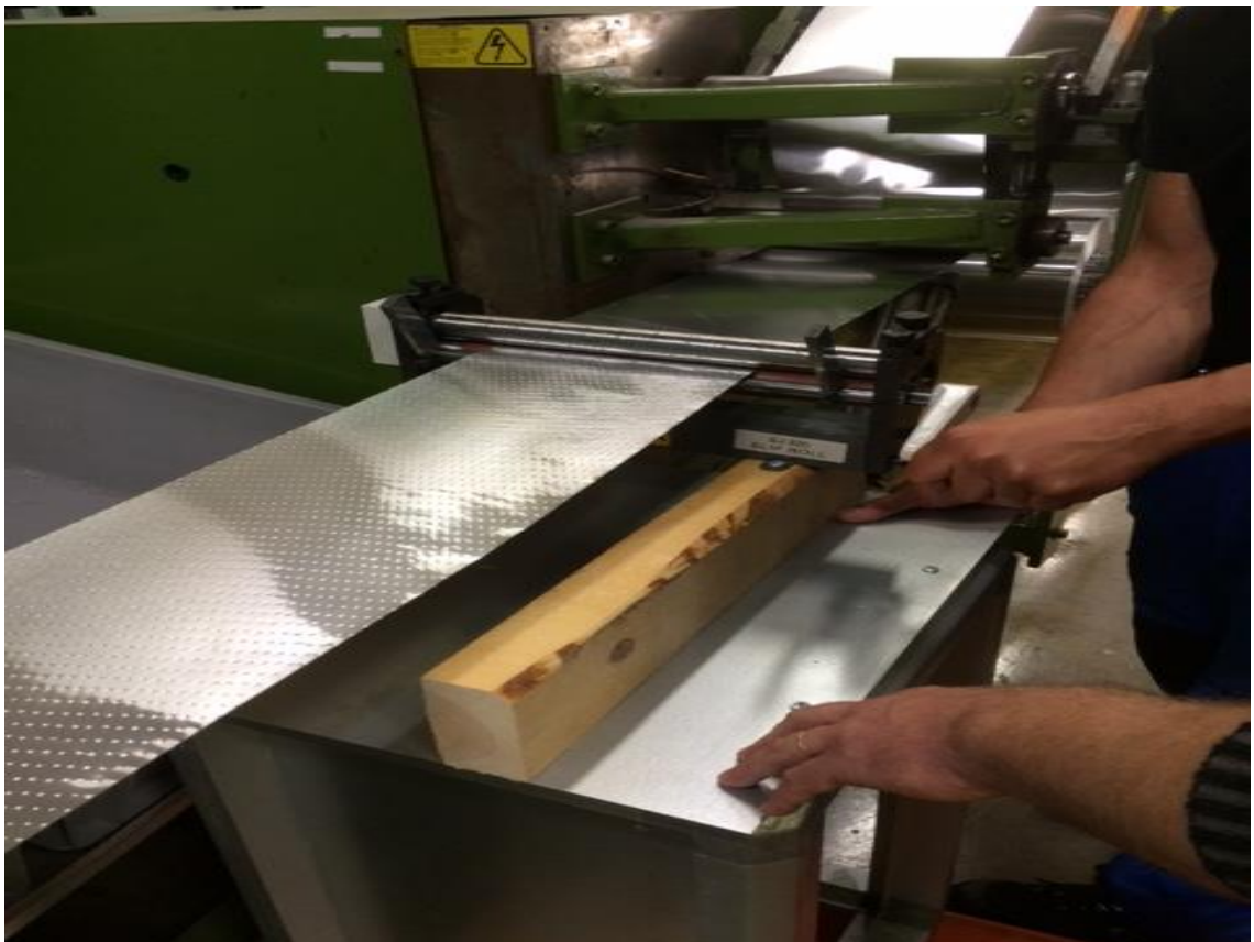
Kuva 8. Kohoumien aikaansaamiseksi sileää alumiinilevyä ajettiin mankelin telojen lävitse ennen kennon rullaamista.
