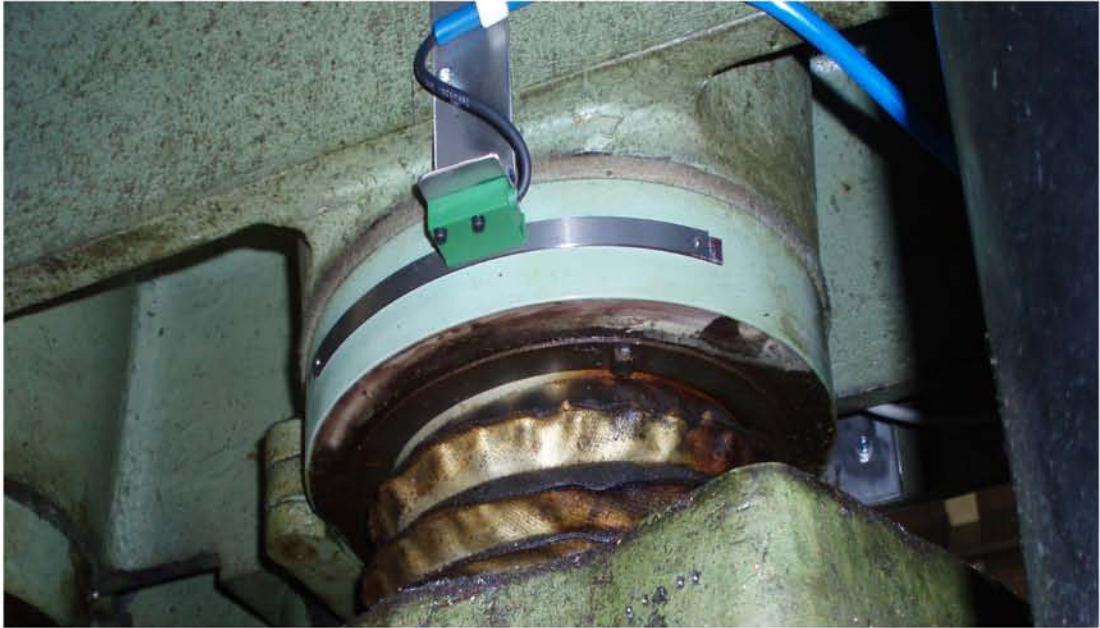
Kuva 24. Siko magneettinauha-anturi asennettuna oikaisukoneen taakse, koneenrunkoon.
