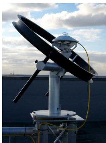
Figur 6. Till vänster en s.k. pyranometer av den typ som använts för att mäta den globala solstrålningen i Övermark. För att mäta den diffusa strålningen från himlen placeras vanligen en ring framför pyranometern, vilken blockerar den direkta solstrålningen.
