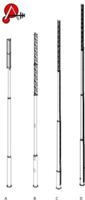
KUVA 7. Aerial-putkimastot (Aerial 2014b, 9.)
