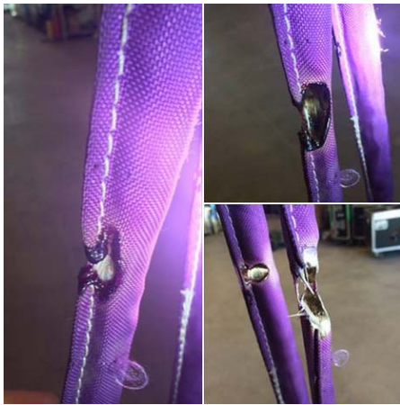
Kuva 8. RMC Oy:n testitilanne beam -tyyppisen valaisimen valokeilan kuumudesta.
