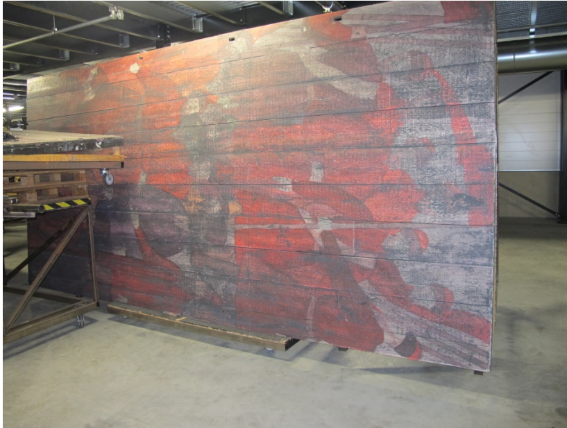
Kuva 46. Paperitulosteella pinnoitettu lattiaelementti kyljellään.
