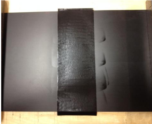
Kuva 20. Liitosfolio asetettuna kuljetinhihnan päälle
