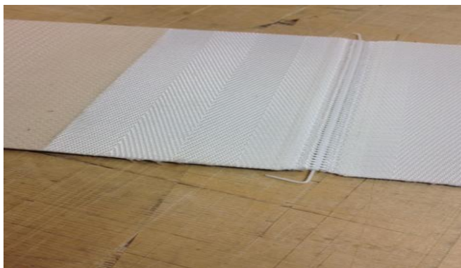
Kuva 30. Valmis ks-hakasliitos lukittuna nylonlangalla.
