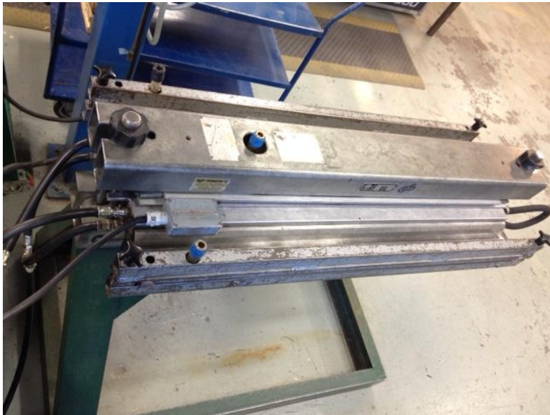
Kuva 15. Rautainen 900 mm leveä puristin jäähdytysletkuineen.
