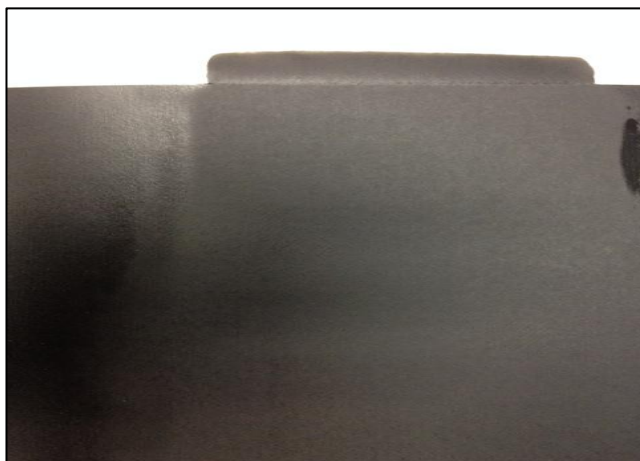
Kuva 22. Reunojen siistimisen jälkeen valmis sormiliitos.
