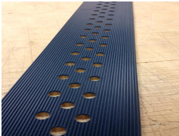
Kuva 8. E 8/2 U0/V5 LG- kuljetinhihna rei'itettyinä.
