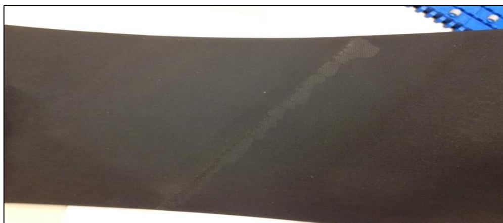
Kuva 26. GG 30P-32 NSTR/FSTR -kuljetinhihnan valmis limiliitos.
