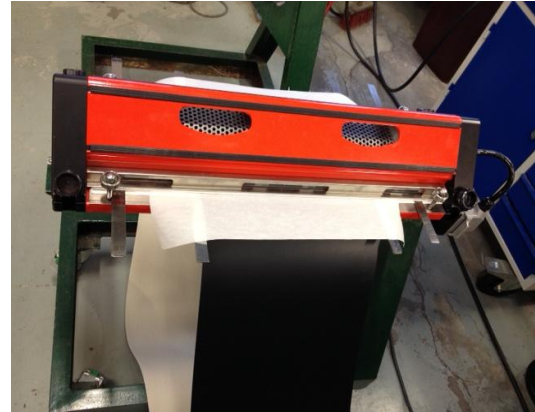
Kuva 21. Kuljetinhihna paistumassa puristimessa listoineen.
