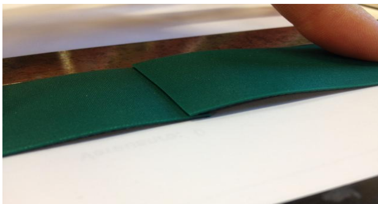
Kuva 31. Kuljetinhihna aseteltuna tyssäysliitokseen.
